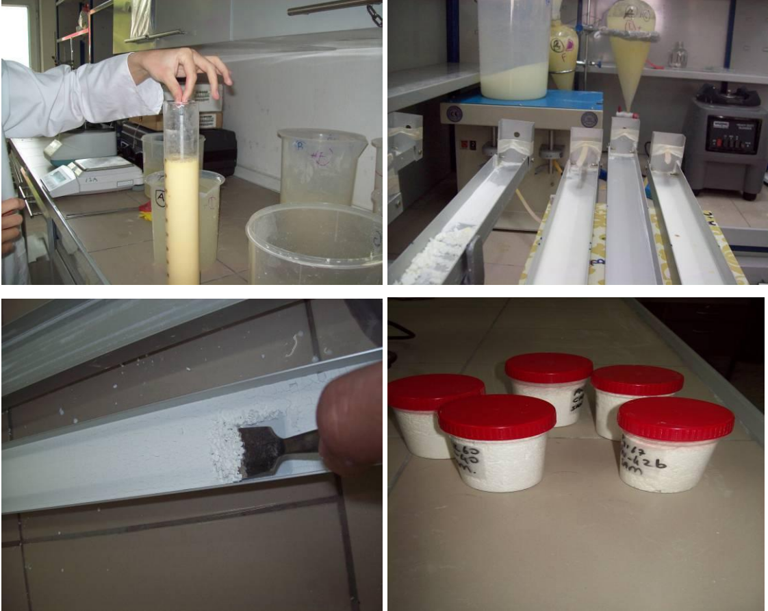
Şekil 3.4. Yaş öğütme işleminde nişasta ve gluten fraksiyonlarının ayrılması
