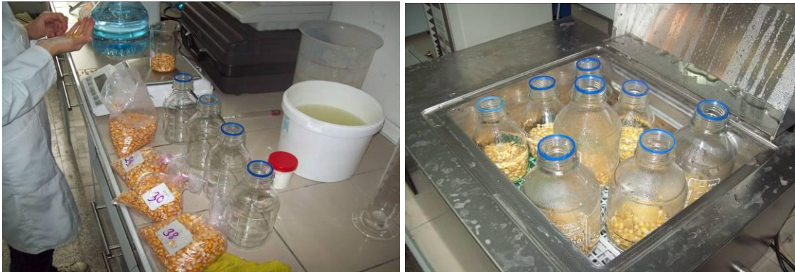
Şekil 3.1. Yaş öğütme işleminde mısırların ıslatılması
