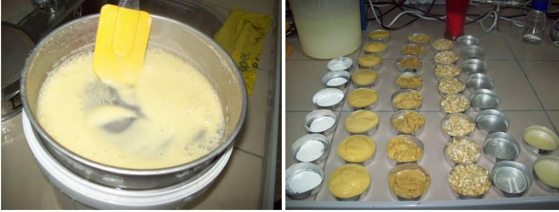
Şekil 3.3. Yaş öğütme işleminde ince öğütme ve kepek fraksiyonlarının ayrılması
