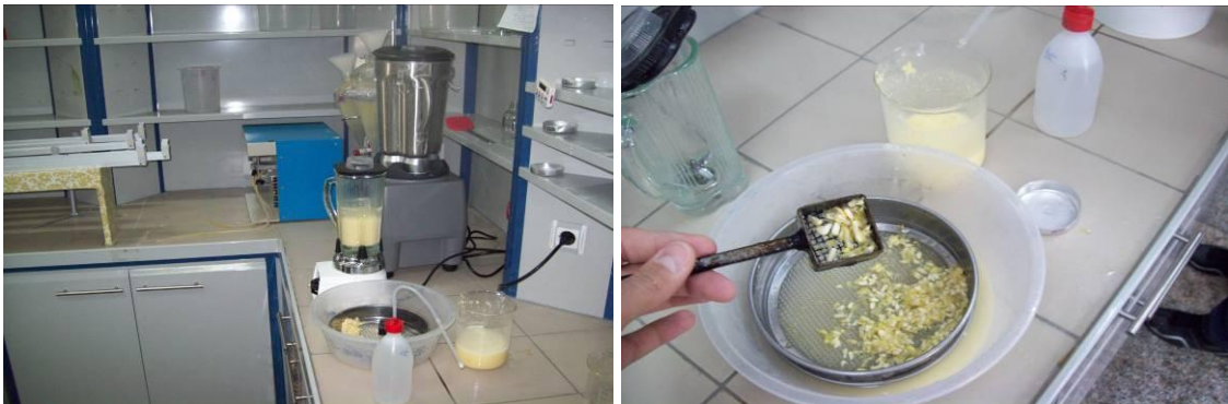
Şekil 3.2. Yaş öğütme işleminde kaba öğütme ve embriyo fraksiyonunun ayrılması
