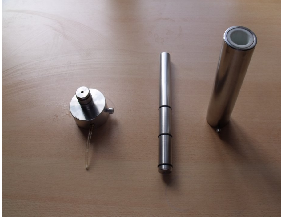
Şekil 3.4. Fransız Presini Oluşturan 3 Ana Parçanın Bir Arada Görünümü.
