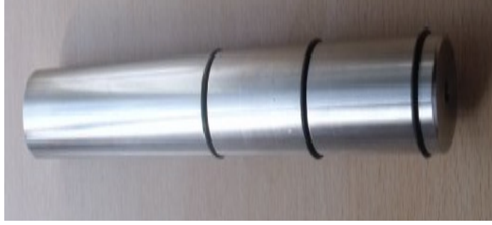
Şekil 3.3. İçi boş silindirin içinde çalışacak piston
