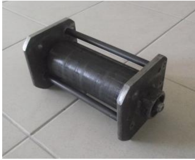
Şekil 3.12. PVC boru ile kaplanmış mıknatıs tambur ve delrinler
