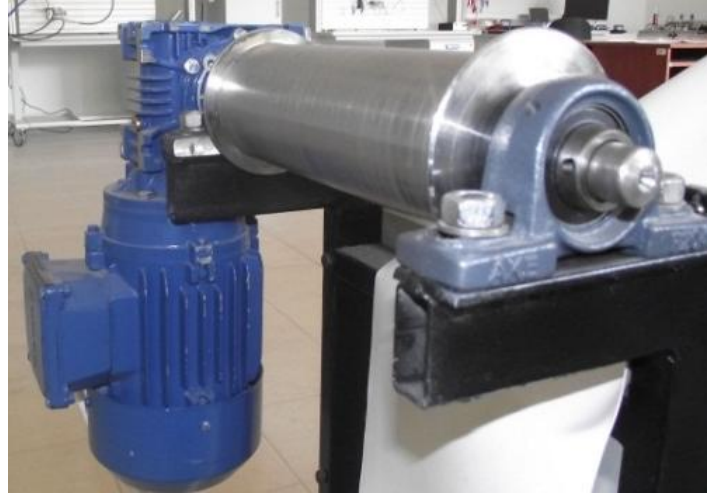
Şekil 3.14. Konveyör banta hareket veren tambur.
