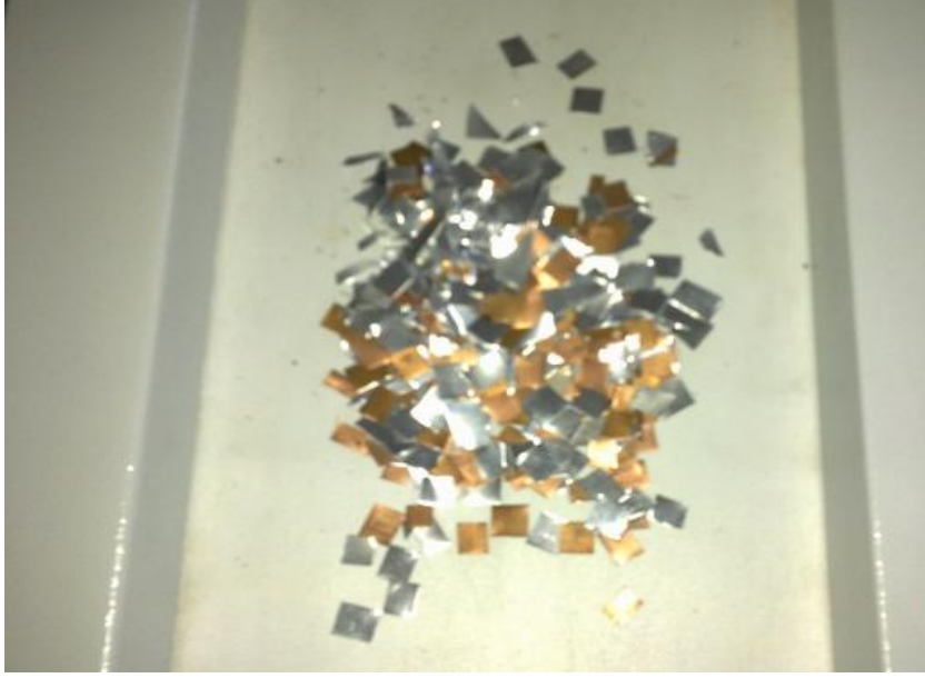
Şekil 3.22. Eddy akımı ayrıştırıcısında küçük parçacıkları ayrıştırma deneyi
