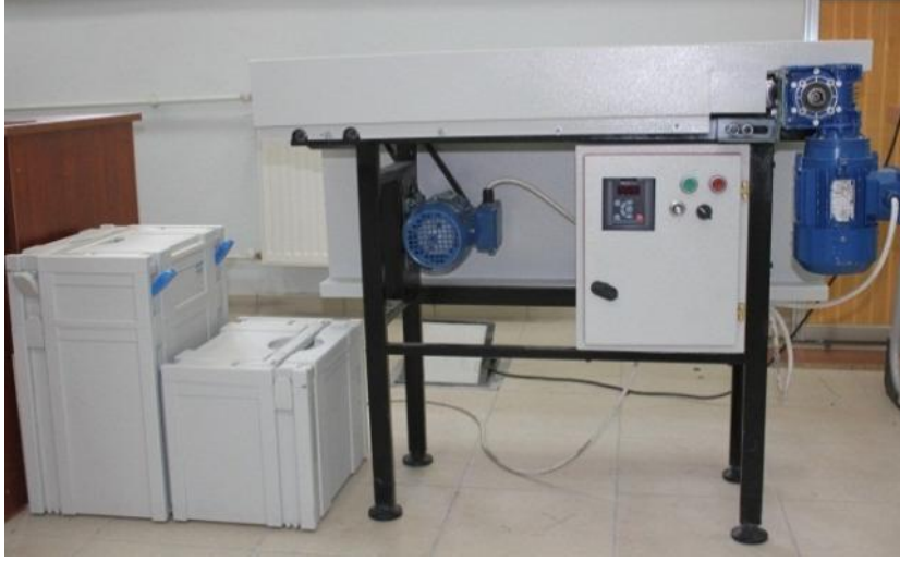
Şekil 3.17. Eddy akım ayırıştırıcısının deney için hazırlanması
