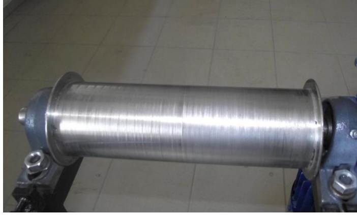
Şekil 3.10. Mıknatıslı tamburun malzemesinin işlenmiş hali.
