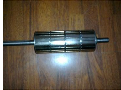
Şekil 3.11. Mıknatıslı tamburun mıknatıslarının yerleştirilmesi.
