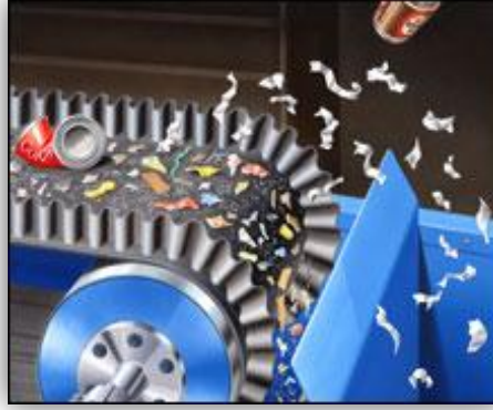
Şekil 3.2. Eddy akımı ayırıştırıcısı ile alüminyumun ayrıştırılması
