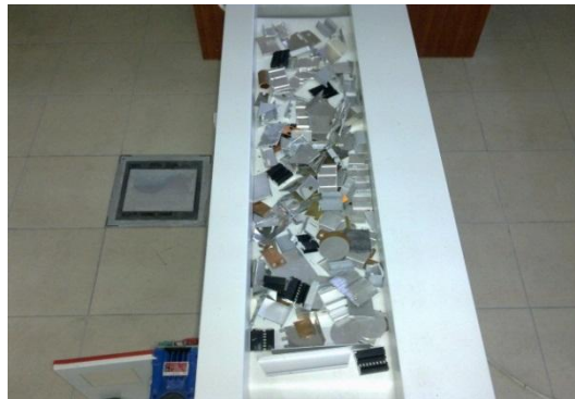
Şekil 3.21. Eddy akımı ayırıştırıcısında verimin bulunması deneyi
