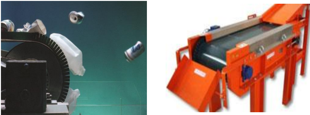
Şekil 1.3. Eddy akım ayrıştırıcısı ve ayırma işlevi
