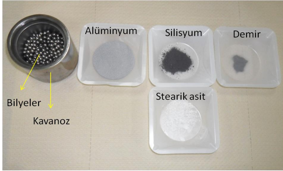
Şekil 3.4. Öğütme işleminde kullanılan paslanmaz çelik hazne (kavanoz), bilyeler, metalik tozlar (Al, Si, Fe) ve üretim esnasında yapışmayı önlemen amacıyla katılan stearik asit
