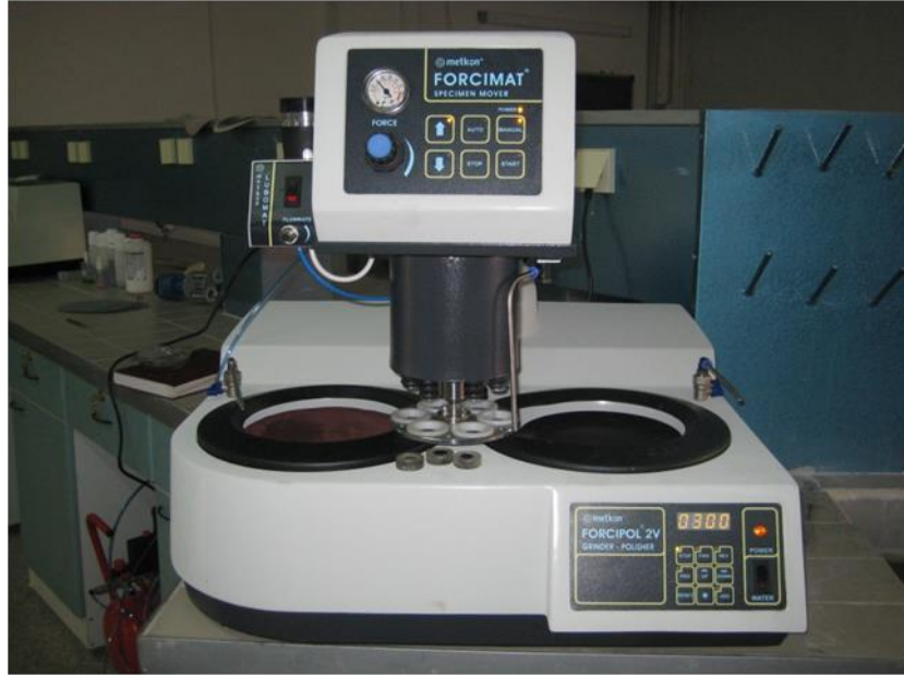
Şekil 3.8. Gaziosmanpaşa Üniversitesi Fen-edebiyat Fakültesi İleri Katıhal Fiziği Laboratuvarında bulunan otomatik kafalı parlatma cihazı
