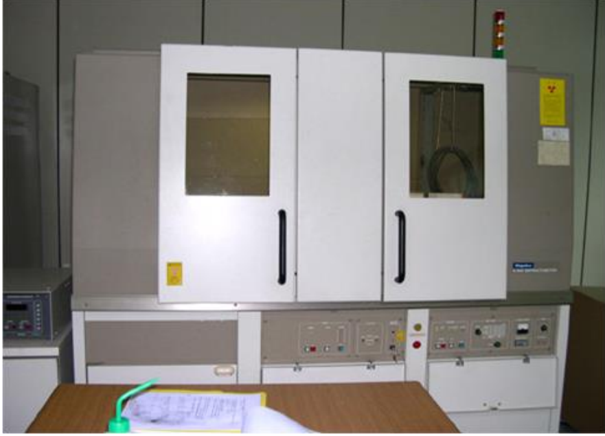
Şekil 3.10. DMAX2000 (XRD) cihazına ait fotoğraflar (Kongju Ulusal Üniversitesi Mühendislik Fakültesi/Güney Kore)
