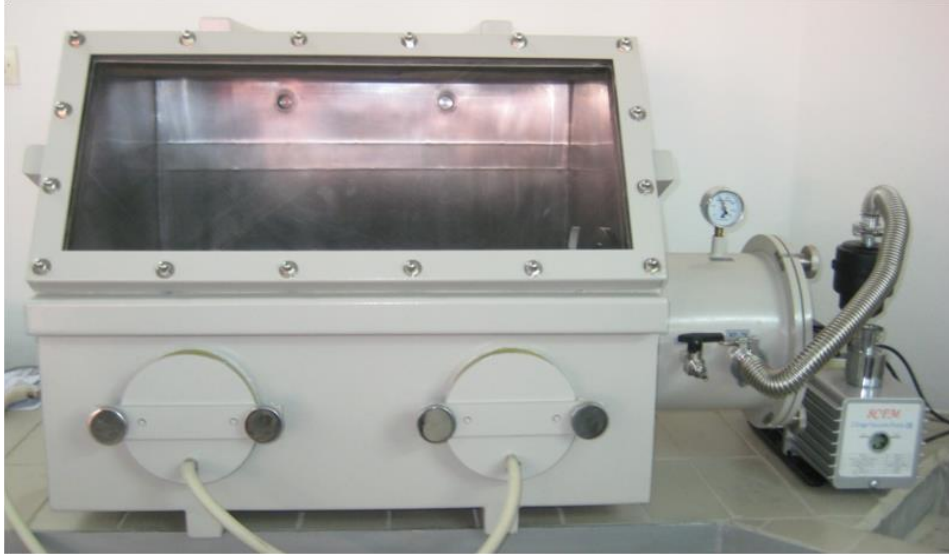
Şekil 3.5. Gaziosmanpaşa Üniversitesi Fen-edebiyat Fakültesi İleri Katıhal Fiziği Laboratuvarında bulunan bilyeli öğütme işleminden önce çelik haznelerin asal ortamda kapatıldığı eldivenli kutunun fotoğrafı
