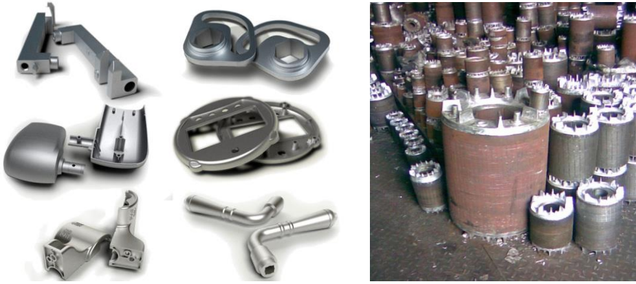
Şekil 2.2. Metal kalıba döküm tekniği ile üretilmiş çinko esaslı parçalar ve motor parçaları
