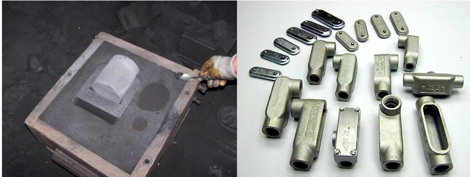
Şekil 2.1. Kum kalıba döküm tekniği ve bu teknikle üretilen parçalar
