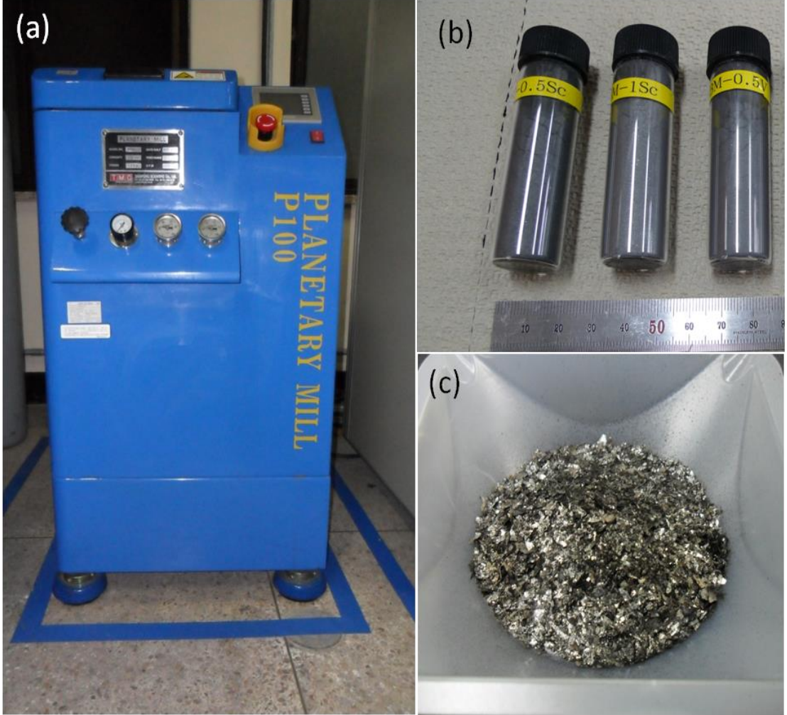
Şekil 3.3. (a) Yüksek enerjili bilyeli öğütme (HEBM) cihazı, (b) Öğütülen toz numunelerin fotoğrafları, (c) Öğütülen şerit numunenin fotoğrafı
