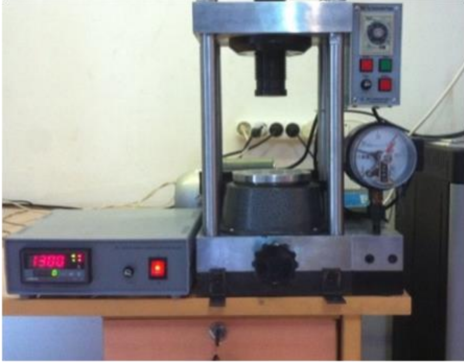
Şekil 3.6. Üretilen örneklerin hacimsel forma getirilmesinde kullanılan sıcak pres cihazı
