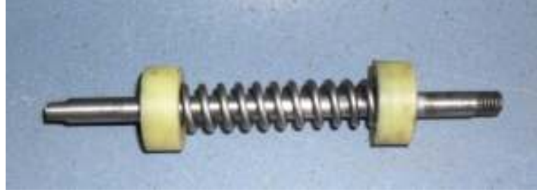
Şekil 5.34 İki Ucu Kestamid ile Kılavuzlanmış Yay Örneği
