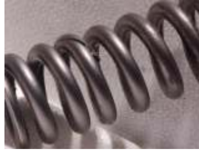
a) Dikdrtgen Kesitli Yayda Oluřan atlak b) Daire Kesitli Yayda Oluřan atlak
