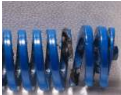
řekil 5.22 Kırık Yay rneklere
