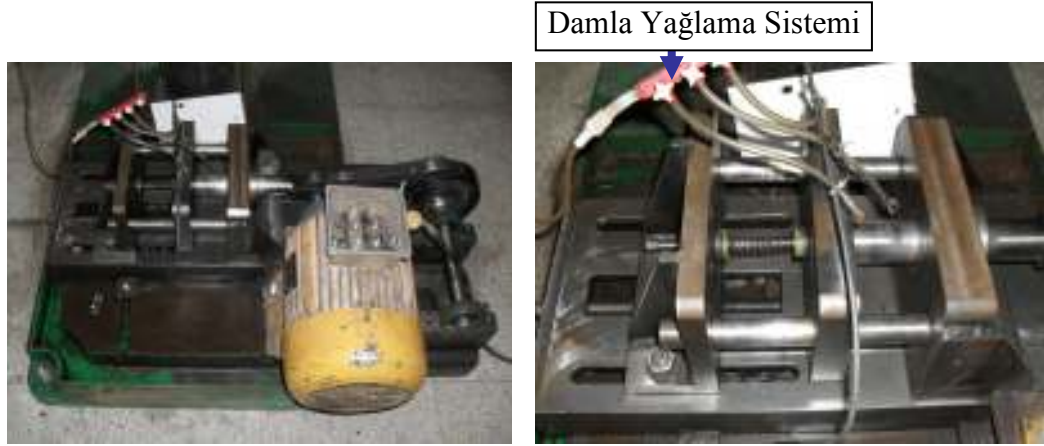
Şekil 5.12 İmalatı Gerçekleştirilen Elektromekanik Yay Yorulma Cihazı
