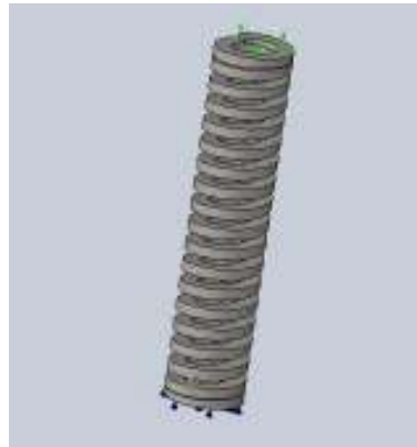
Şekil 5.44 Dikdörtgen Kesitli Yay için Sınır Koşulları ve Yükleme Şartları
