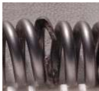
řekil 5.22 Kırık Yay rneklere
