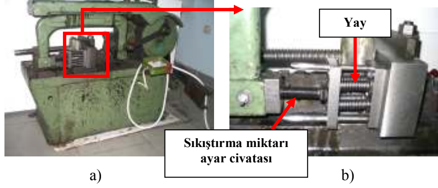
Şekil 5.3 Kollu Testere Tezgahından Dönüştürülmüş Mekanik Yay Yorulma Düzeneği
