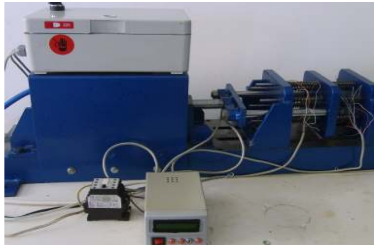
Şekil 5.10 Yük Tekrar Sayısını Belirleyen Sayaç Sistemi
