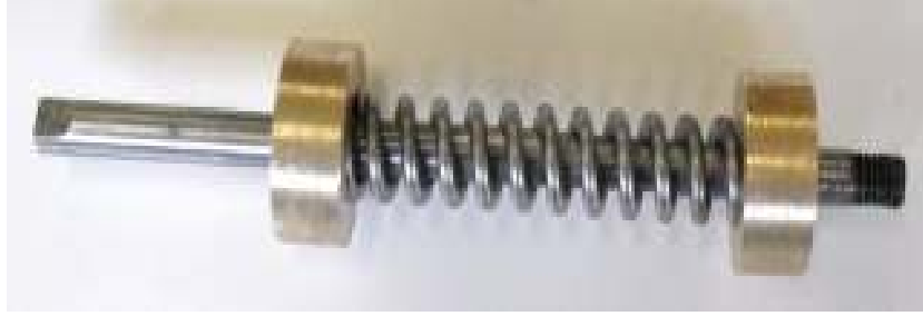
Şekil 39 İki Ucu Pirinç ile Kılavuzlanmış Yay Örneği
