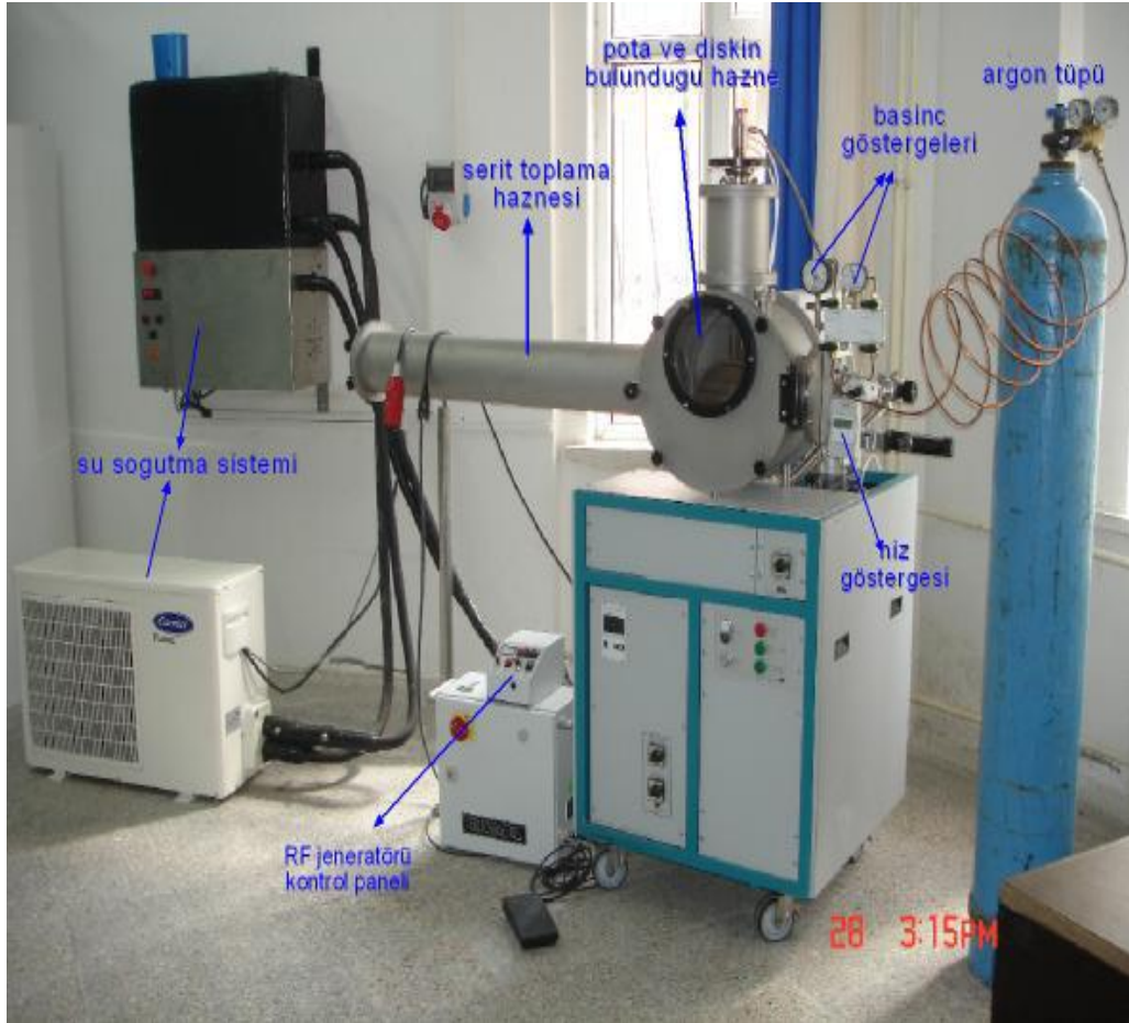
Şekil 3.2. Eriyik-eğirme (Melt-Spinning) sistemi
