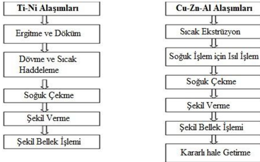
Şekil 2.22. Ti-Ni ve Cu-Zn-Al alaşımlarının üretim prosesleri
