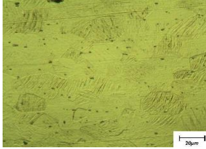
Şekil 2.13. Şekil bellekli alaşımların tane sınırları ve ikizlenmiş yapılar (Sarı, 2009)
