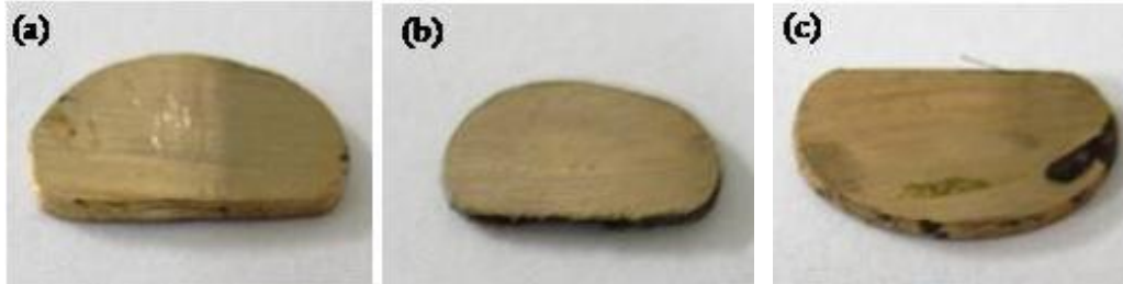
Şekil 3.6. Mastır alaşımlardan plaka şeklinde kesilmiş numuneler
