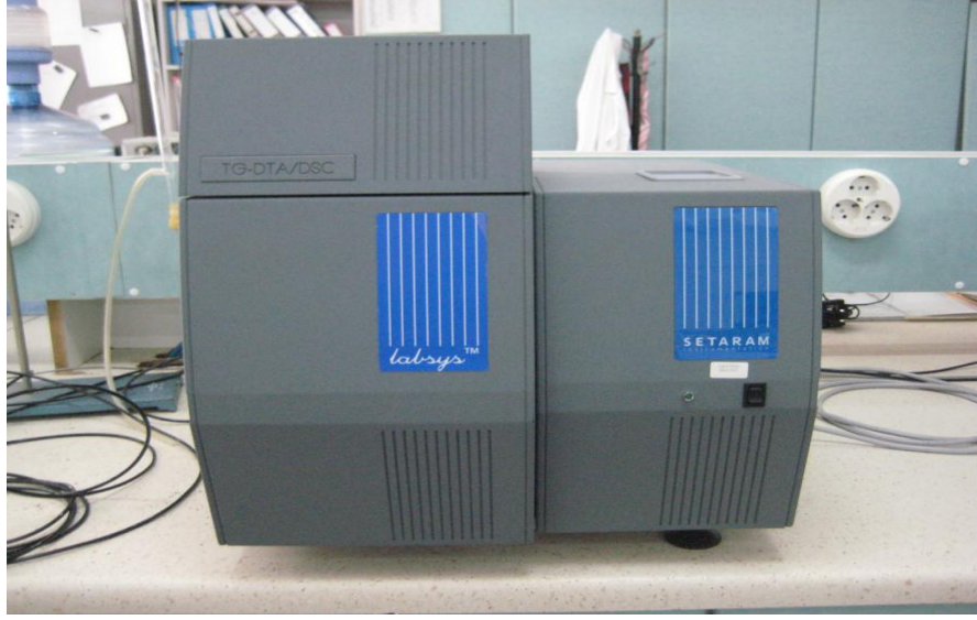
Şekil 3.10. Faz dönüşüm sıcaklıkları analizinin yapıldığı DSC Cihazı
