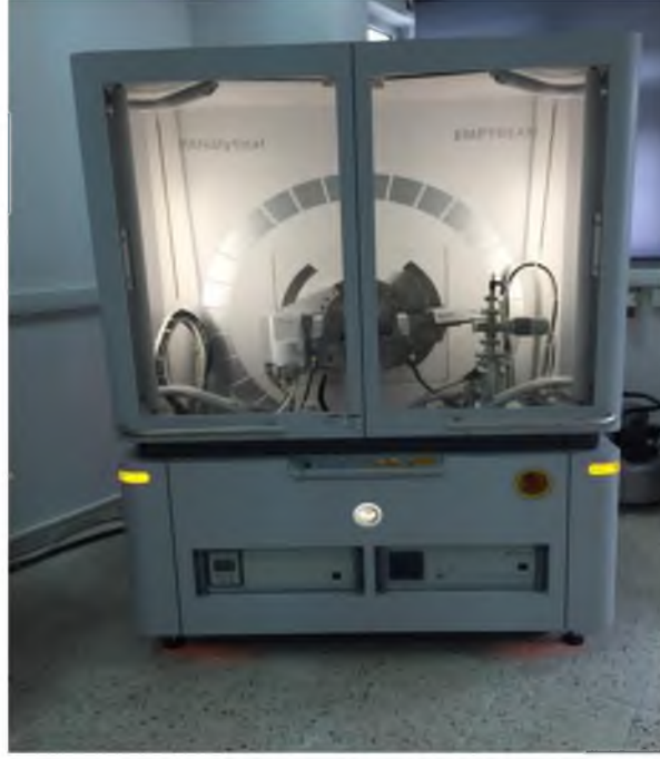
Şekil 3.8. X-ışını kırınımı analizlerinde kullanılan cihazın fotoğrafı.
