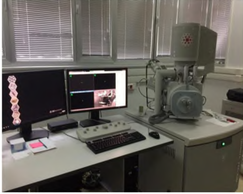
Şekil 3.7. SEM analizlerinde kullanılan cihazın fotoğrafı.
