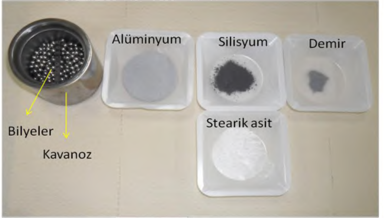
Şekil 3.2. Öğütme işleminde kullanılan paslanmaz çelik hazne (kavanoz), bilyeler, metalik tozlar (Al, Si, Fe) ve üretim esnasında yapışmayı önlemen amacıyla katılan stearik asit.
