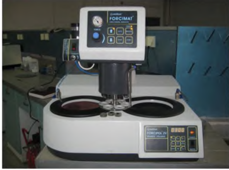
Şekil 3.6. Numunelerin parlatma işlemlerinde kullanılan otomatik kafalı parlatma cihazı.
