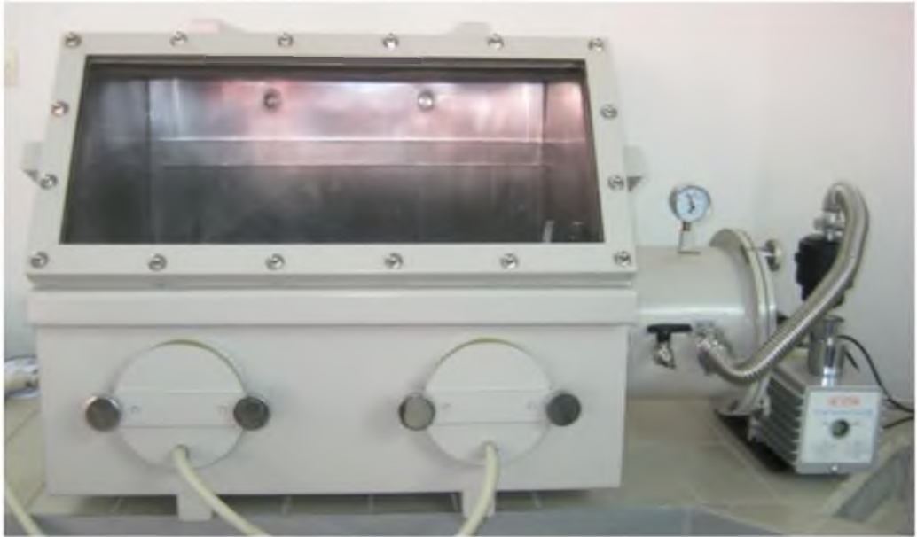
Şekil 3.3. Bilyeli öğütme işleminden önce çelik haznelerin asal ortamda kapatıldığı eldivenli kutunun fotoğrafı.
