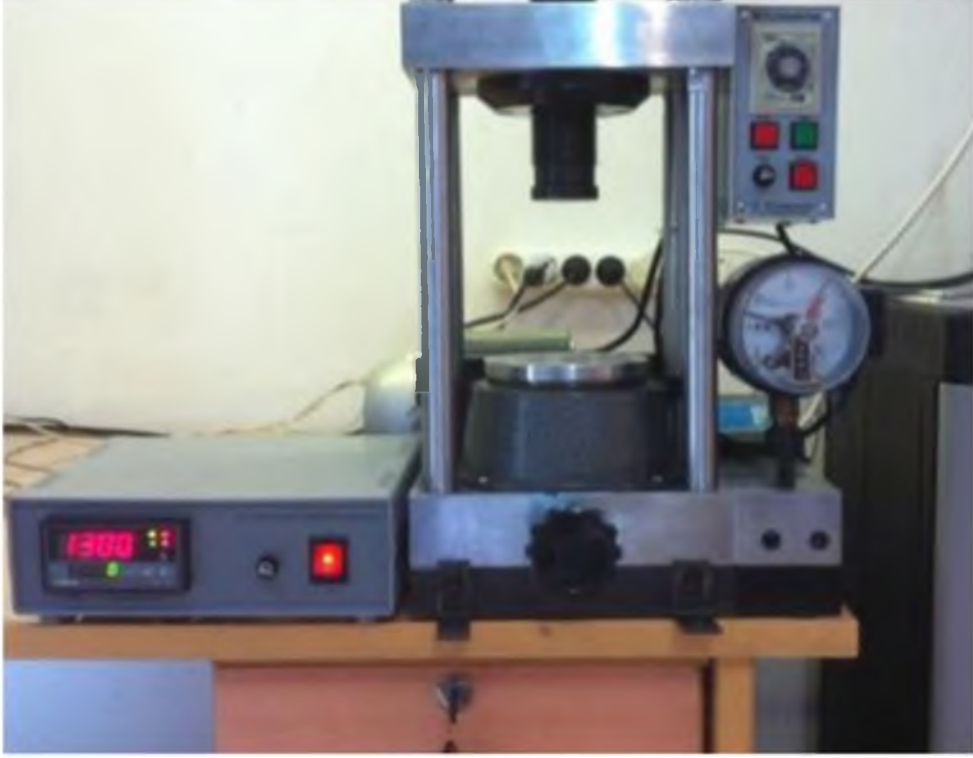
Şekil 3.4. Üretilen örneklerin hacimsel forma getirilmesinde kullanılan sıcak press cihazı.
