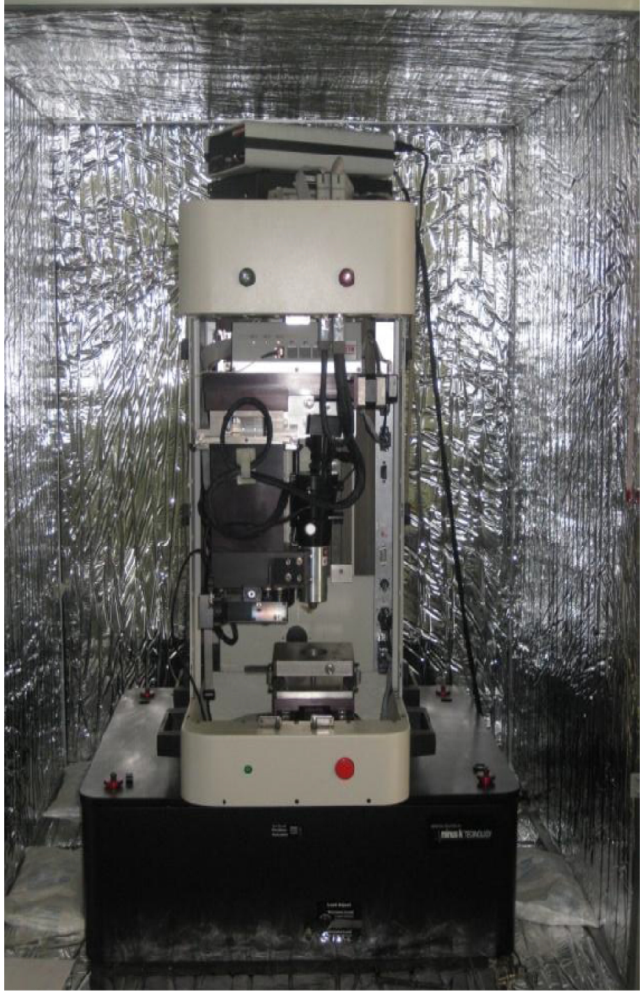
ekil 3.3. Nano-çentik test cihazı (UMT/NH-2, Bruker)
