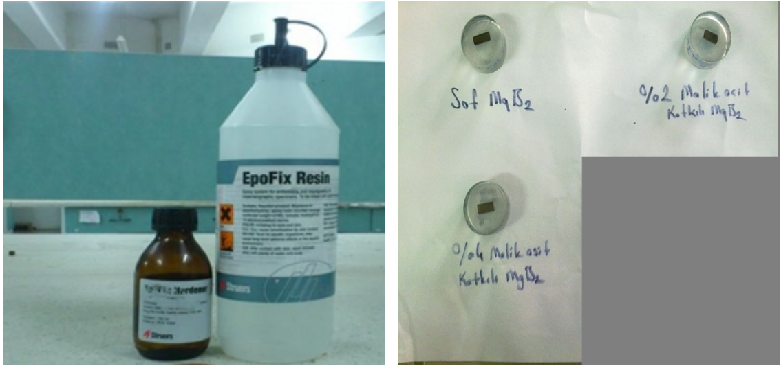
ekil 3.1. Kullanılan kalıp malzemeleri ve kalıplanmış numune örneği
