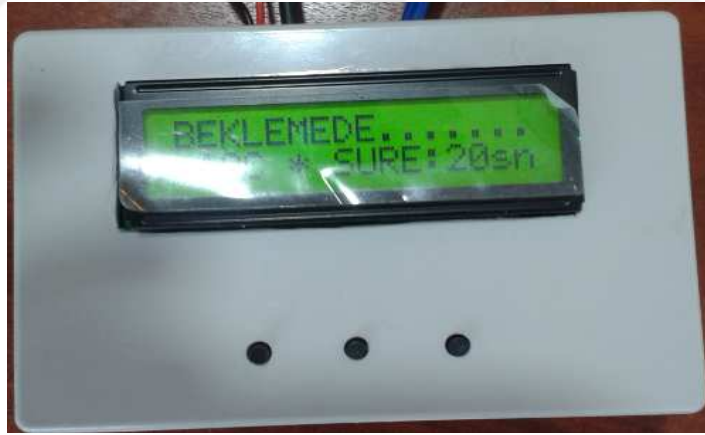
Şekil 3.9. Sıcaklık Kontrol Paneli
