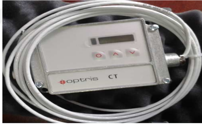
Şekil 3.10. Temassız kızılötesi sıcaklık sensörü
