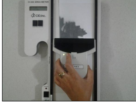
Şekil 3.15. Areametre ile yaprak alanı ölçümü
