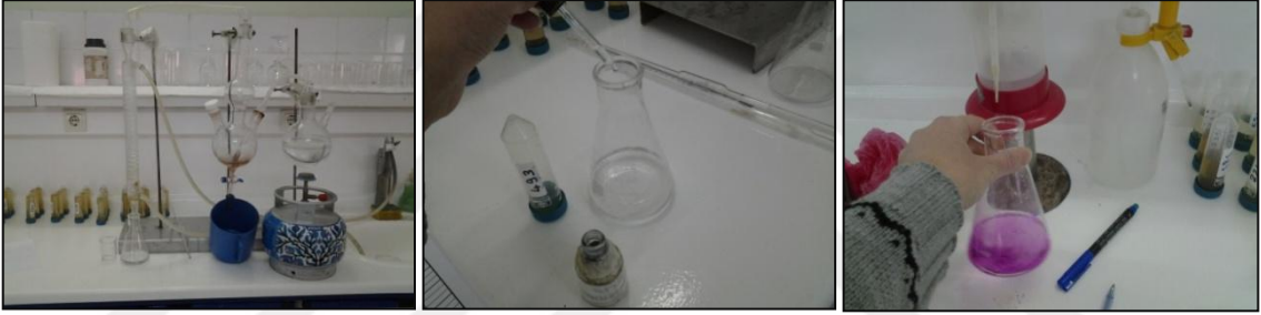
Şekil 3.25. Buharlı damıtma yöntemiyle uçar asit tayini
