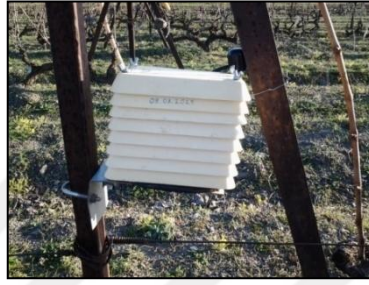
Şekil 3.5. HOBO cihazının görüntüsü
