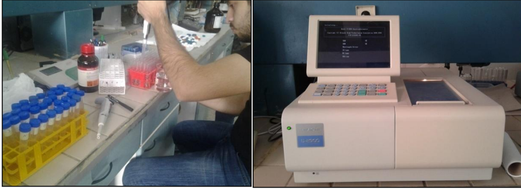
Şekil 3.28. Spektrofotometre ile toplam fenolik bileşik ve toplam flavonoid tayini
