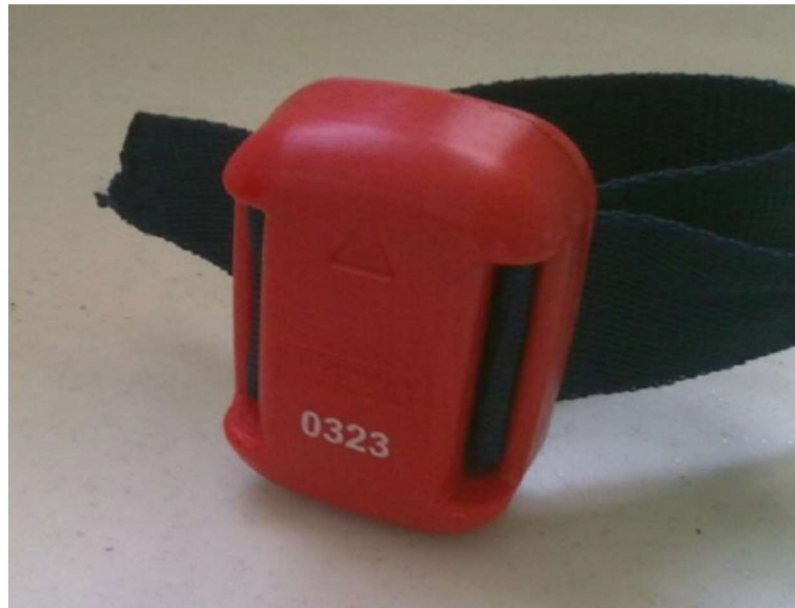
Şekil 3.10. Hareket ölçümünde kullanılan pedometre
