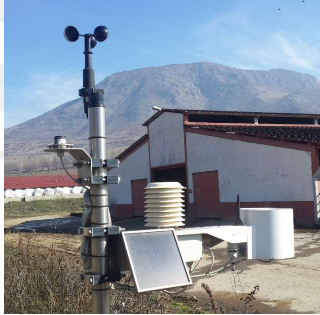
Şekil 3.6. Tarım işletmesine kurulan iklim istasyonu
