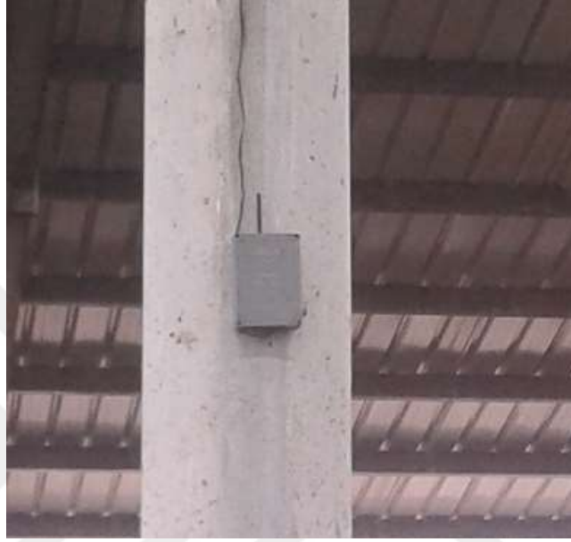
Şekil 3.11. Hareket takip sistemi ara istasyonu
