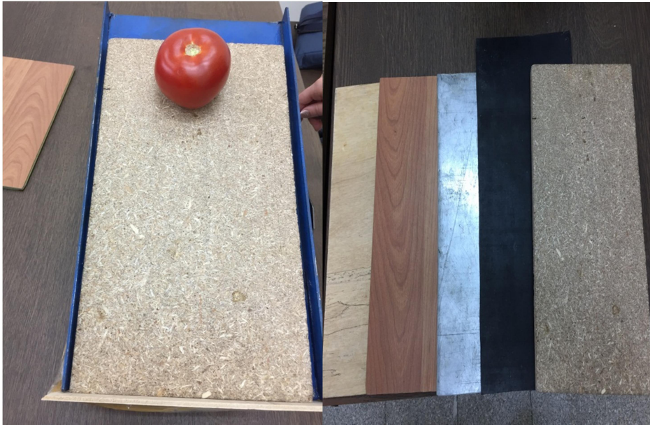
Şekil3.5. Eğimli masa düzeneği ve sürtünme yüzeyleri
