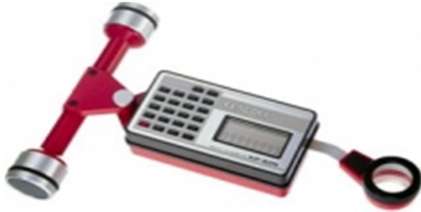
Şekil 3.7. Kutupsal kollu roller tip dijital planimetre
