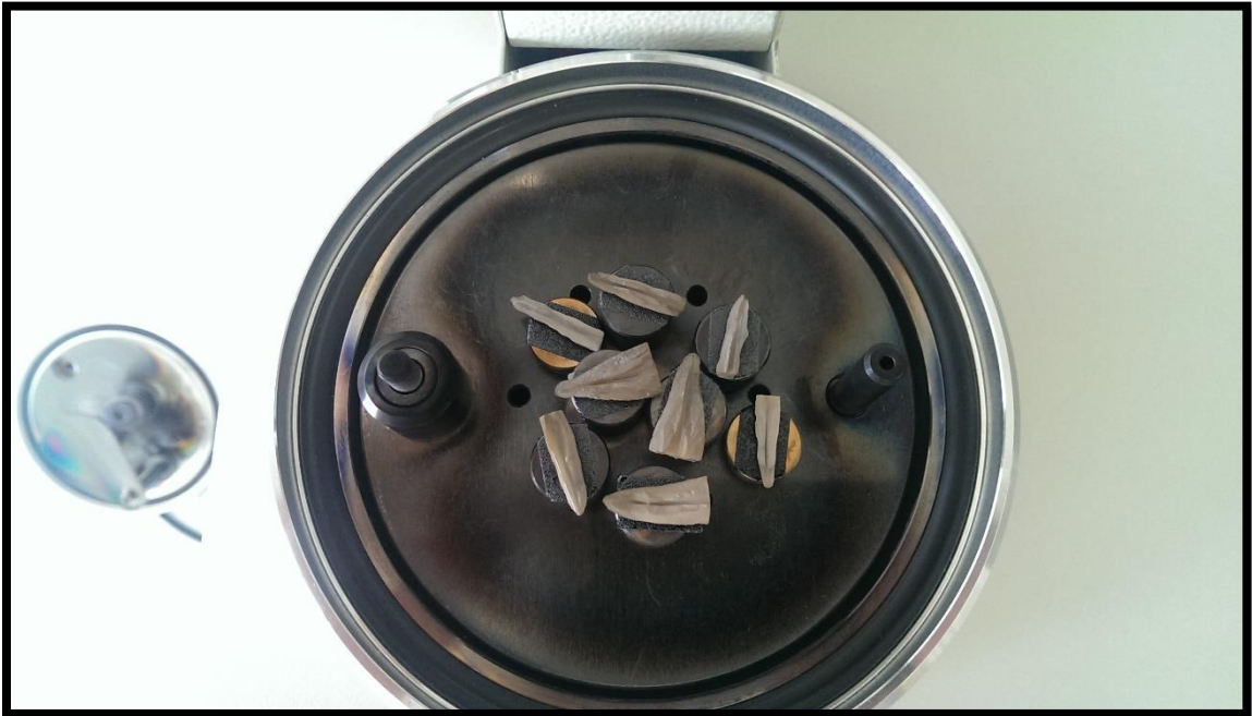
Şekil 3.12: Çalışmada kullanılan altın ile kaplanmış dişlerin görünümü
