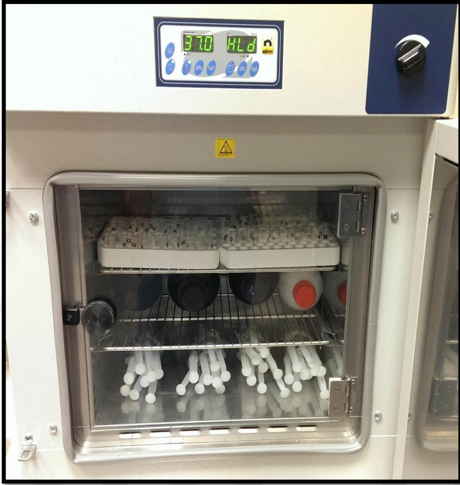
Şekil 3.9: 37 °C’de (vücut sıcaklığında) etüvde bekletilen solüsyonlar ve dişler
