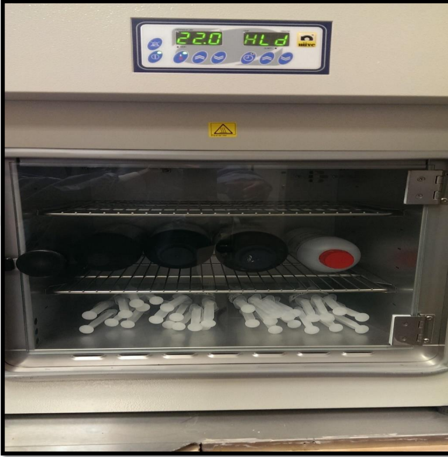
Şekil 3.8: 22 °C'de (oda sıcaklığında) etüvde bekletilen solüsyonlar
