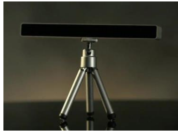
Şekil 3.2. Smarttek Eye Navigator göz izleme cihazı
