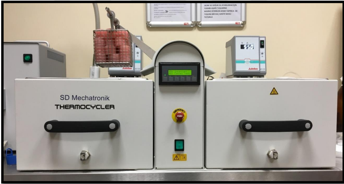
Şekil 3.8: Çalışmada kullanılan termal yaşlandırma cihazı (Thermocycler THE 1100, SD Mechatronik, Feldkirchen-Westerham, Almanya).
