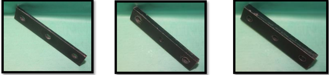
Şekil 3.11: Örneklerin hazırlanması için kullanılan 2 mm, 4 mm ve 6 mm kalınlığında metal kalıplar.
