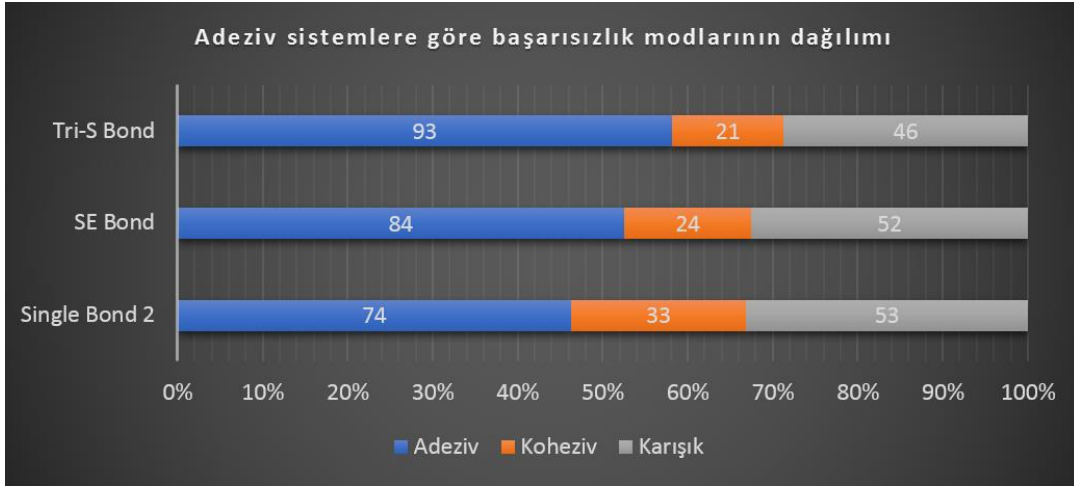
Şekil 4.5. Adeziv sistemlere göre başarısızlık tiplerinin yüzde (%) olarak dağılımı.
