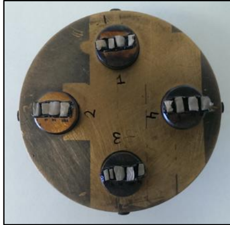
Şekil 3.16. Görüntüleme öncesi vakumlanıp Au-Pd kaplama yapılmış örnekler.
