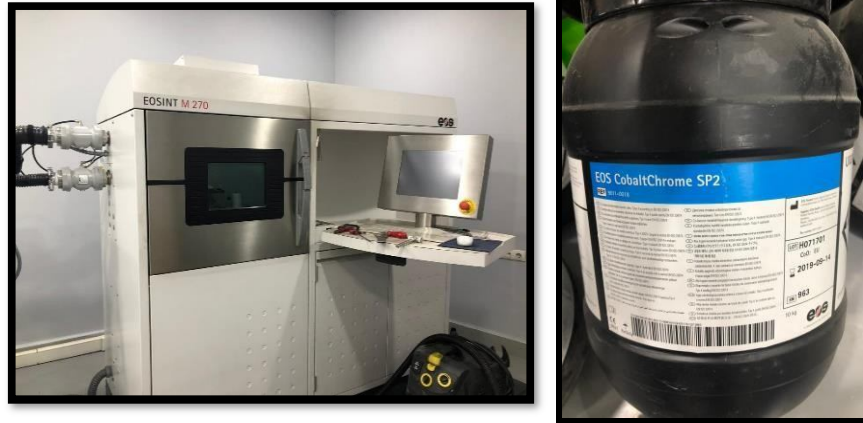
Şekil 3.1.a. Metal alt yapıların üretimi b. metal alaşım tozu (Eos Cobalt Chrome SP2)
