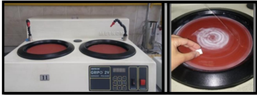
Şekil 3.3.a Zımparalama ve parlatma cihazı b. Örneklerin Zımparalanması
