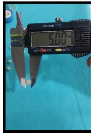
Şekil 3.13.a. Vita Mark □ blokların kazınması b. Üst yapı boyutlarının ölçülmesi
