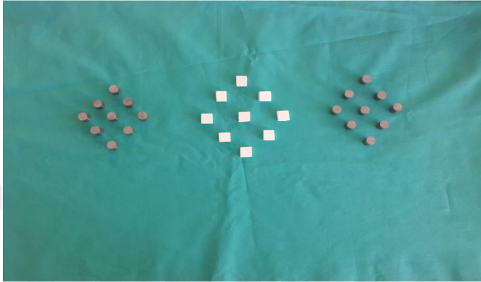
Şekil 3.4. Hassas kesme cihazında kesilen örnekler
