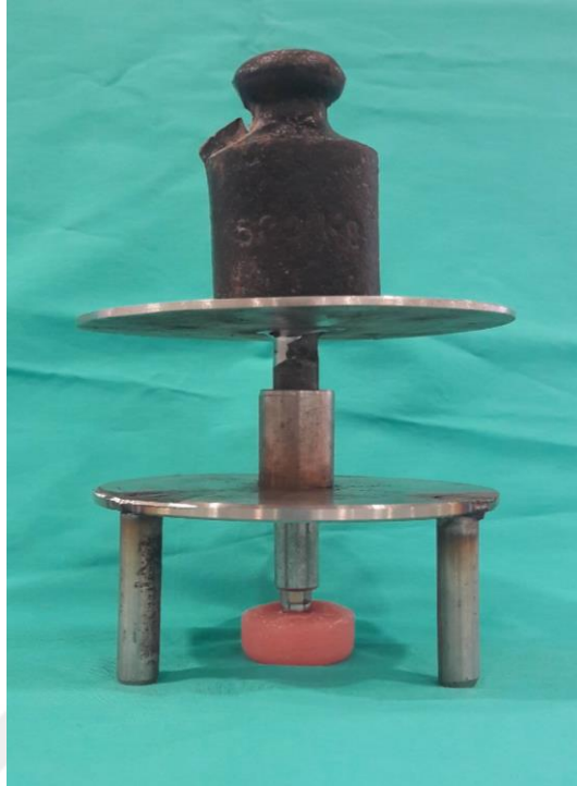
Şekil 3.22. 500 gr'lık ağırlığın düzenek aracılığıyla uygulanması
