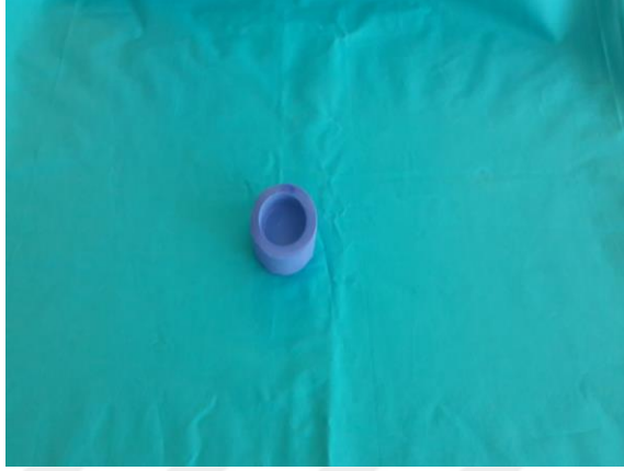
Şekil 3.12. Örneklerin akrile gömülmesinde kullanılan silikon kalıp
