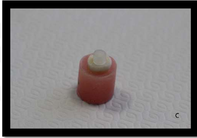
Şekil 3.6.: Akrilik bloğa gömülmüş numune ve Silikon Silindirik Kalıp
