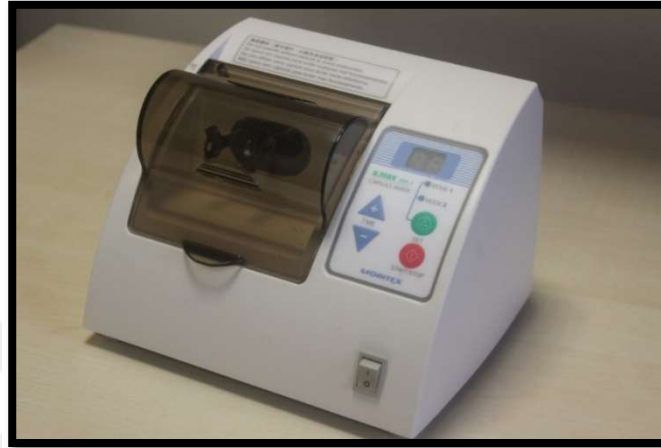
Şekil 3.2.: Çalışmada kullanılan materyallerin karıştırılması için kullanılan kapsül karıştırıcı. (Functional Capsule Mixer, Monitex industrial/ New Taipei City 24158, Tayvan)
