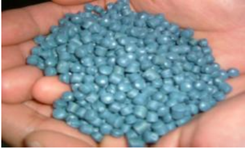
Şekil 3.8 PE Ambalaj Atıklarından Elde Edilen Granül
