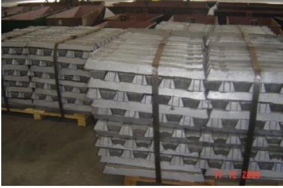
Şekil 3.9 Metal Ambalaj Atığından Elde Edilen Külçeler
