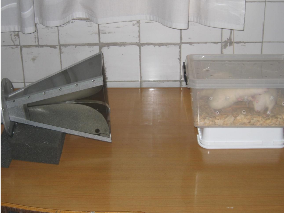
Şekil 16. Deney sırasında deney hayvanları horn antenden 10 cm. uzaklıkta plastik kutu içerisine yerleştirildi.
