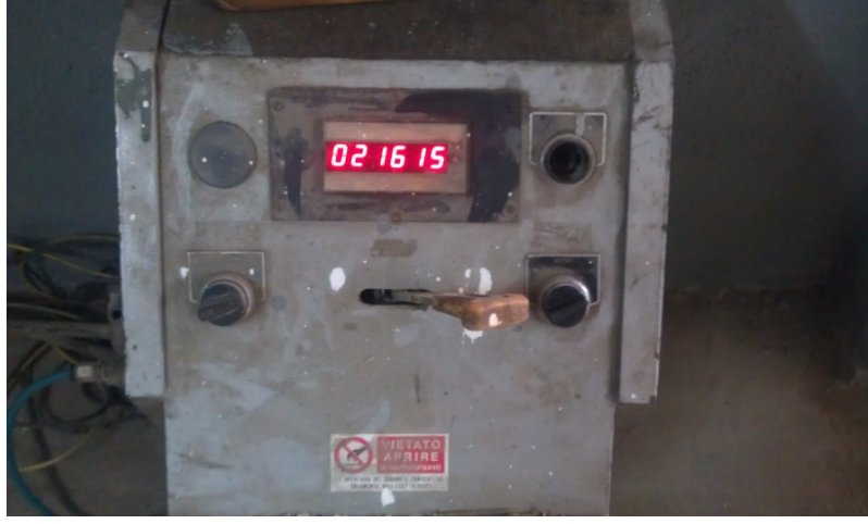
Şekil 6.10: Yorulma tezgâhi kontrol paneli ve çevrim sayacı
