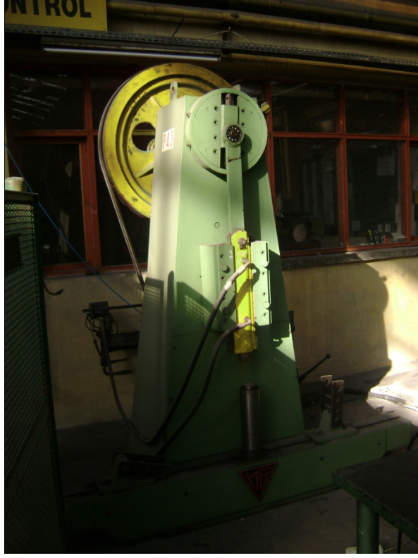
Şekil 6.7: Makas yormak için kullanılan yorulma tezgahı
