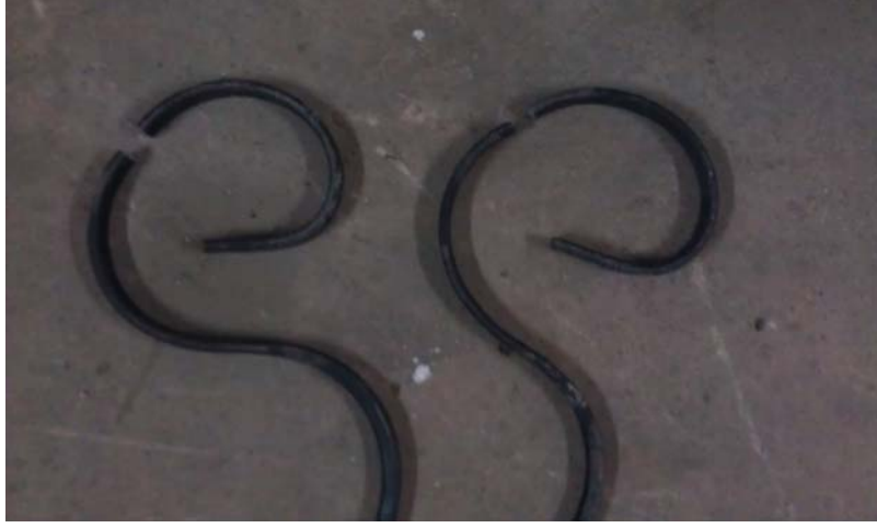
Şekil 6.13: Test sırasında kırılan ayaklar
