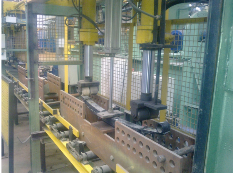
Şekil 6.3: Makas bağlanmış stresli kumlama tezgâhı
