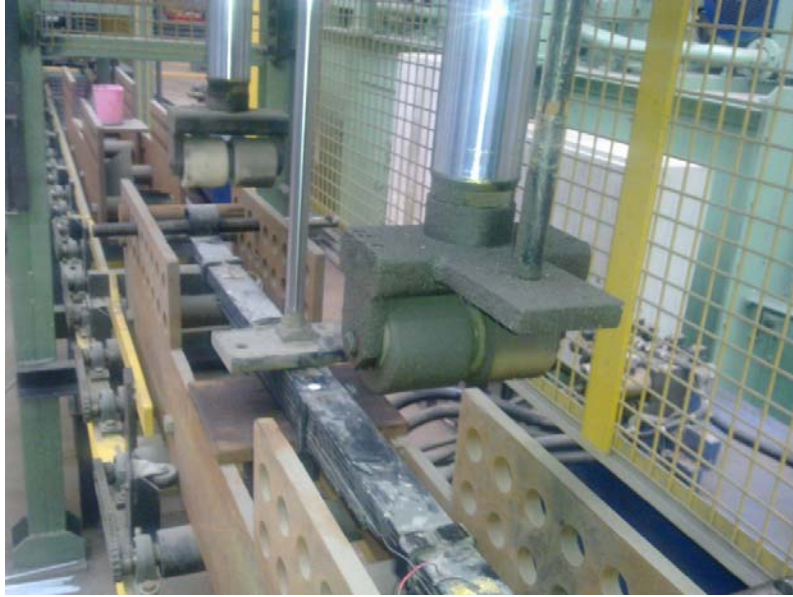
Şekil 6.4: Düz konuma getirilmiş makas bağlı stresli kumlama tezgâhı
