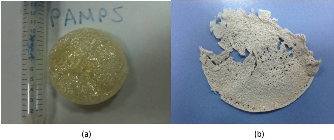
Şekil 3.6 (a) Poli (2-akrilamid-2-metil-1-propan sülfonik asit) (PAMPS) (b) PAMPS-NMPA-hBN
