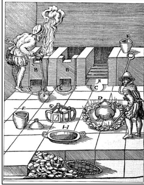
Şekil 2 142 Altının kükürt kullanarak gümüşten arındırılması
