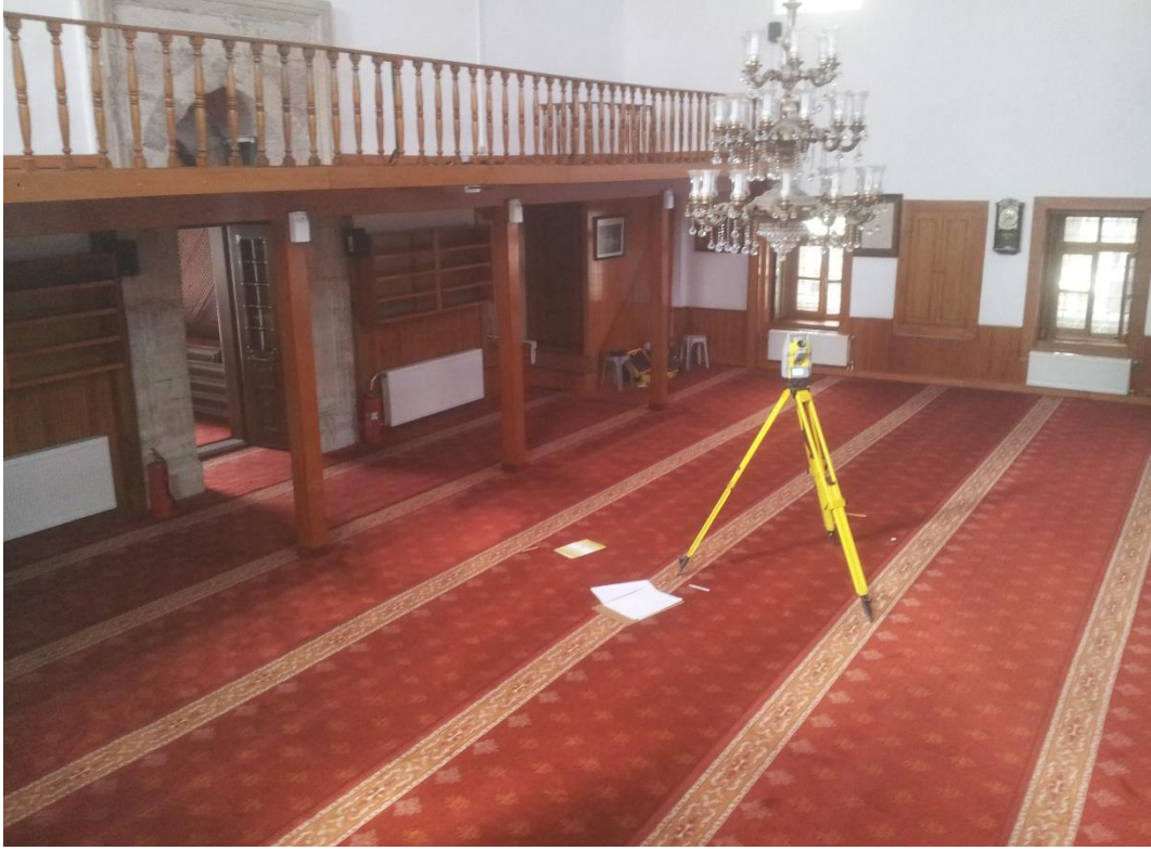
Şekil 2 :Total Station ile Harim Tarama Fotoğrafi (A.Aluç 2014)
