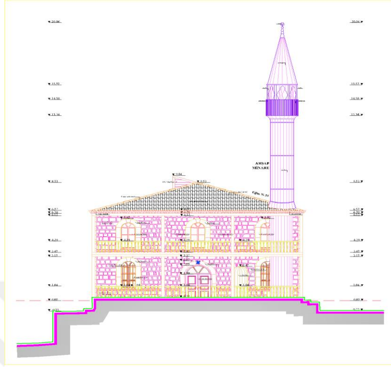
Şekil 6.11 Kaya Camii 1.Dönem Raspa Çalışması (Kuzey Cephe), 2016
