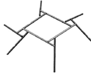
Şekil 4.40 : Üç ve dört kirişli modüllerden oluşan mütekabil strüktür [Baverel ve diğ. s:156]
