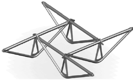
Şekil 4.24 : Dört kirişten oluşan temel sistem modülü[Gelez, Aubry ve Vaudeville s:305]
