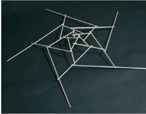
Resim 4.21: Farklı boyda kirişlerden oluşan pozitif ve negatif yöndeki modüllerle karmaşık kirişleme [Larsen, 2008 s:30]
