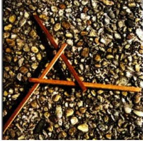
Resim 4.5 : Üç elemandan oluşan açıklık geçen modül [Bertin, s:23]
