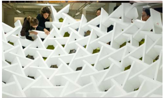
Resim 3.12 : Kesilen EPS parçaların birleştirilmesi [Schwarz, Mondardini s:207]
