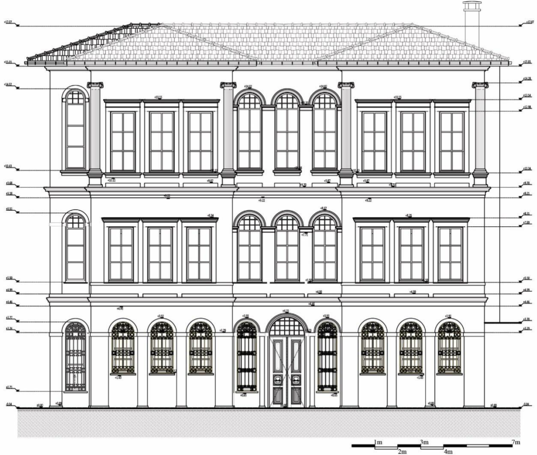
EK 66 : Kuzeybatı cephesi - İkinci restitüsyon projesi
