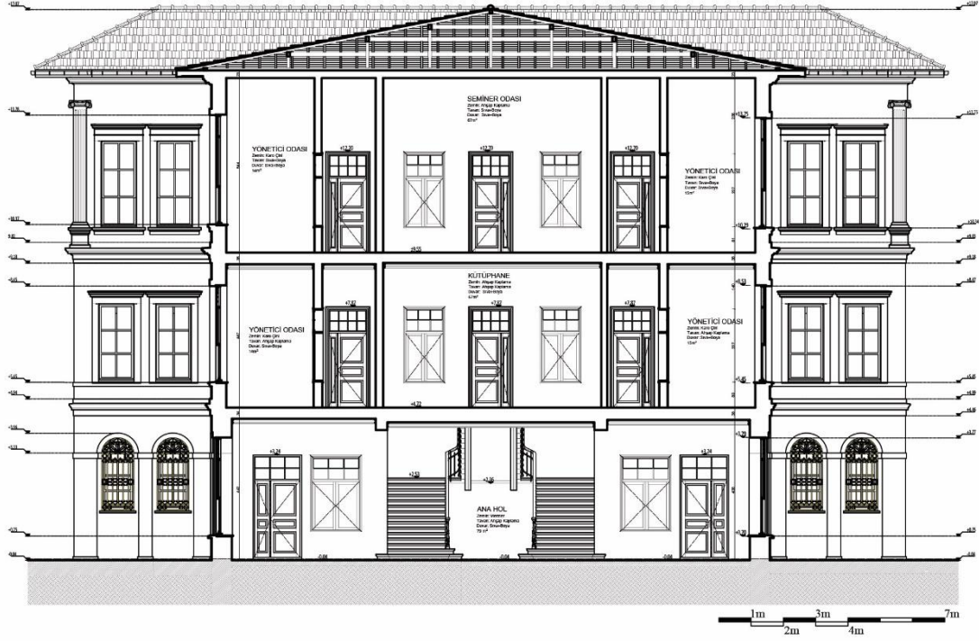
EK 62 : A-A kesiti - İkinci restitüsyon projesi
