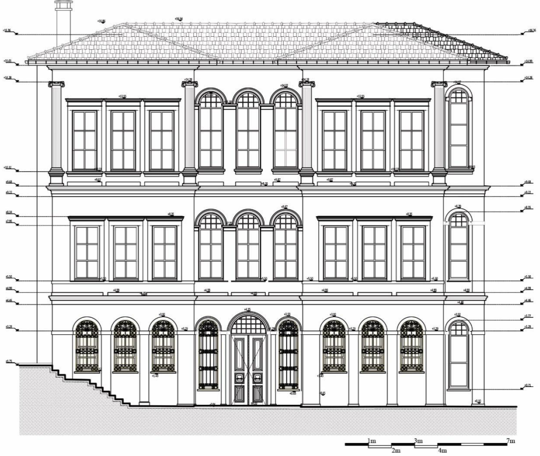
EK 64 : Güneydoğu cephesi - İkinci restitüsyon projesi
