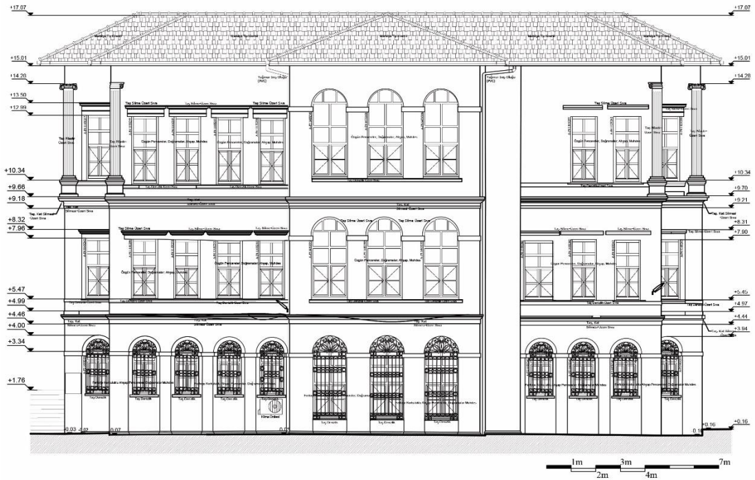
EK 14 : Kuzeydoğu cephesi - Rölöve
