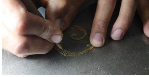
Resim 200: Elmas uçlu araçla, pirincin arkasına tarama işlemi yapılıyor. (Tez yazarı,2017)
