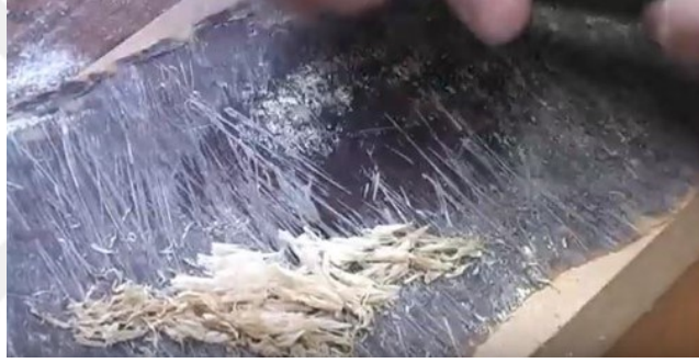
Resim 99: Bağa malzemesi tesviye 27 edilirken Kaynak ( https://www.youtube.com/watch?v=oinOCIRvBPk )
