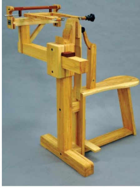
Resim 96: Chevalet (tezgâh testersi) (Furniture & Cabinetmaking Eylül 2015, sy.5)
