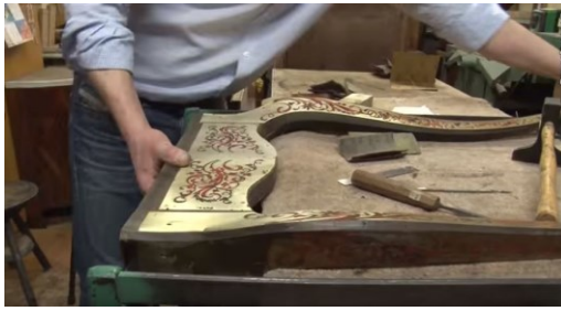
Resim 115: Mobilya yüzeyine Boulle-marküteri montaj uygulaması
