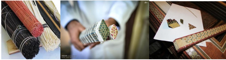
Resim 81: İnce ince zımparalanıp tutkal veya ip ile sarılarak birleştirilen malzemelerin plaka haline getirildiği görüntüler ( http://tahahandicraft.com )
