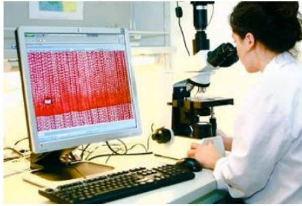
Resim 210: Mikroskop altında incelenen ahşabın cins/tür tayini (Doğan, 2015, sy.92)
