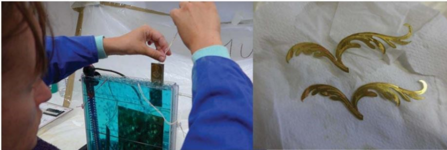
Resim 130: Metal malzemeler üzerinde oyma işleminin asite indirme yönteminin uygulanması (Prevet,2016, sy.156)
