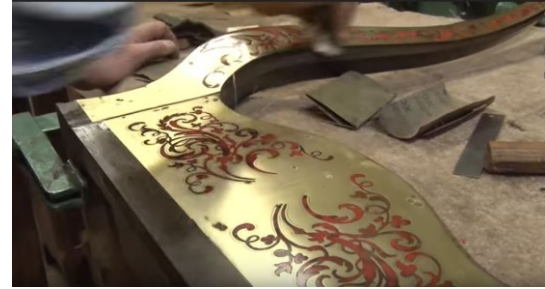
Resim 115: Mobilya yüzeyine Boulle-marküteri montaj uygulaması
