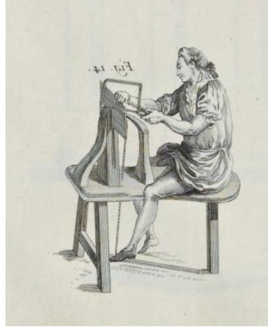
Resim 104: Chevalet” Terminolojisi; “Testere tezgahı” çizimi (Andre Roubo,1769, Sy.292)
