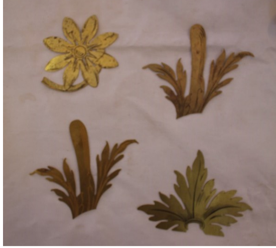
Resim 197: Asit indirme tekniği ile kesimi ve oyma işlemi yapılan pirinç motifler (Tez yazarı,2017)
