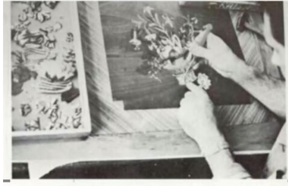
Resim 64: Kakma tekniği ile süsleme sanatına bir örnek; kakma yapılacak parçaları yerine yerleştirmek cımbız ve bunun gibi küçük aletlerle hassas çalışmayı gerektirir. (Ramond,1989:18)
