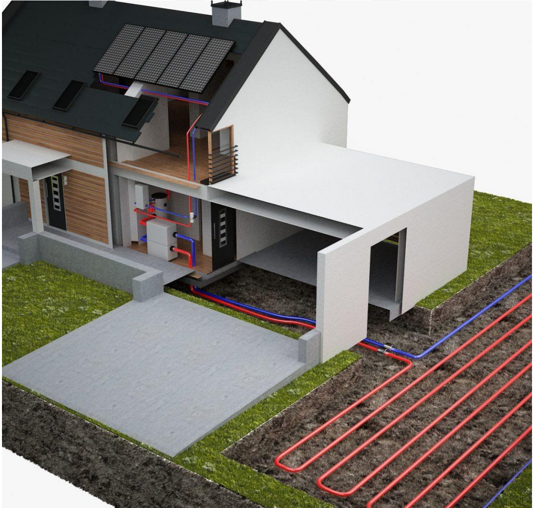
Şekil 3.14: Yatay tip ısı pompası (Seyrek, 2010).
