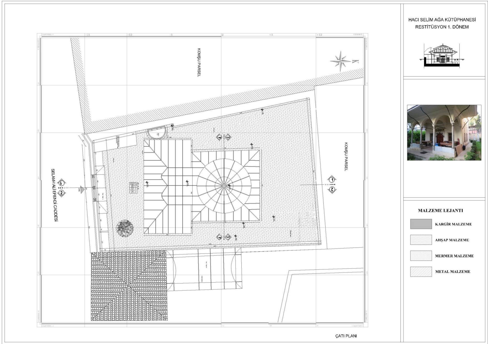
Şekil 39: Restitüsyon Projesi I Çatı planı
