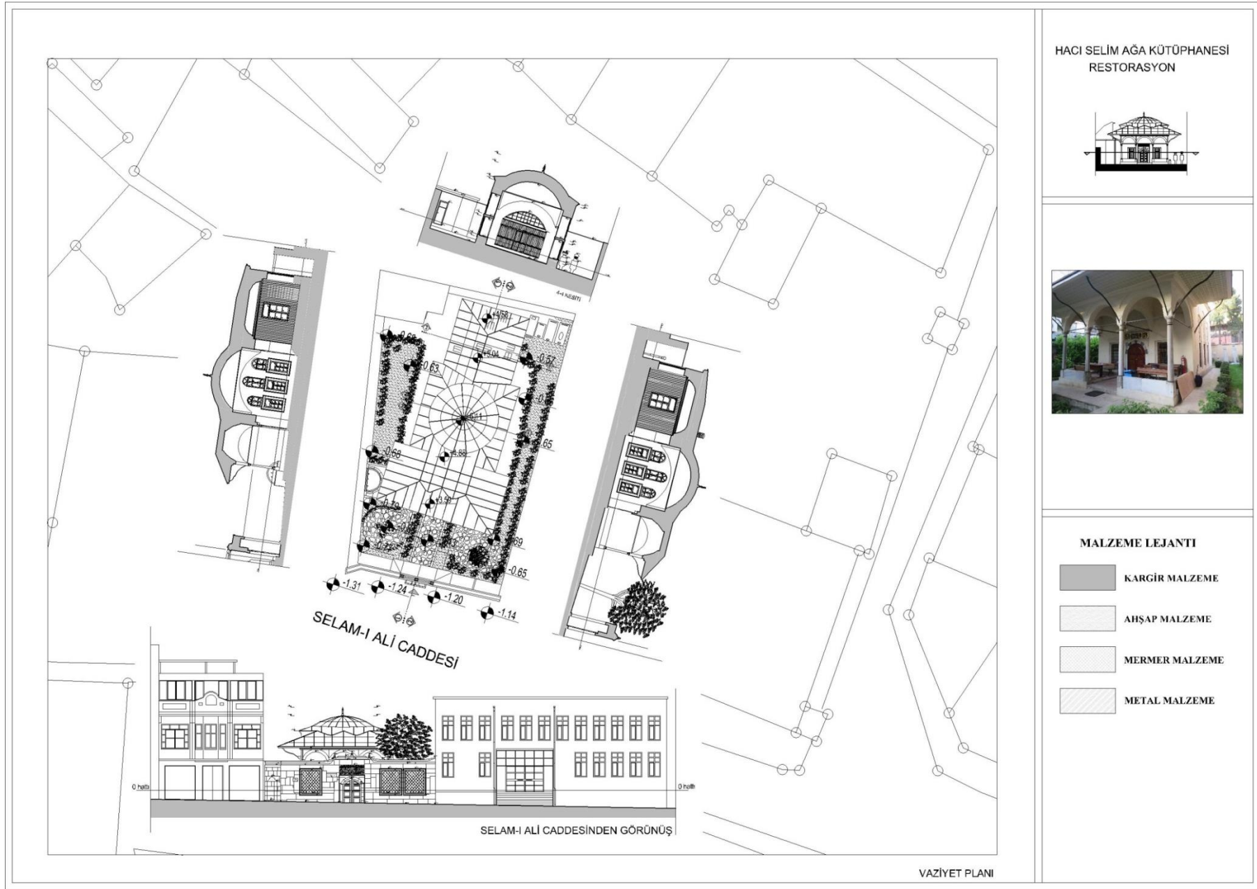
Şekil 104: Restorasyon Projesi Kesitli vaziyet planı
