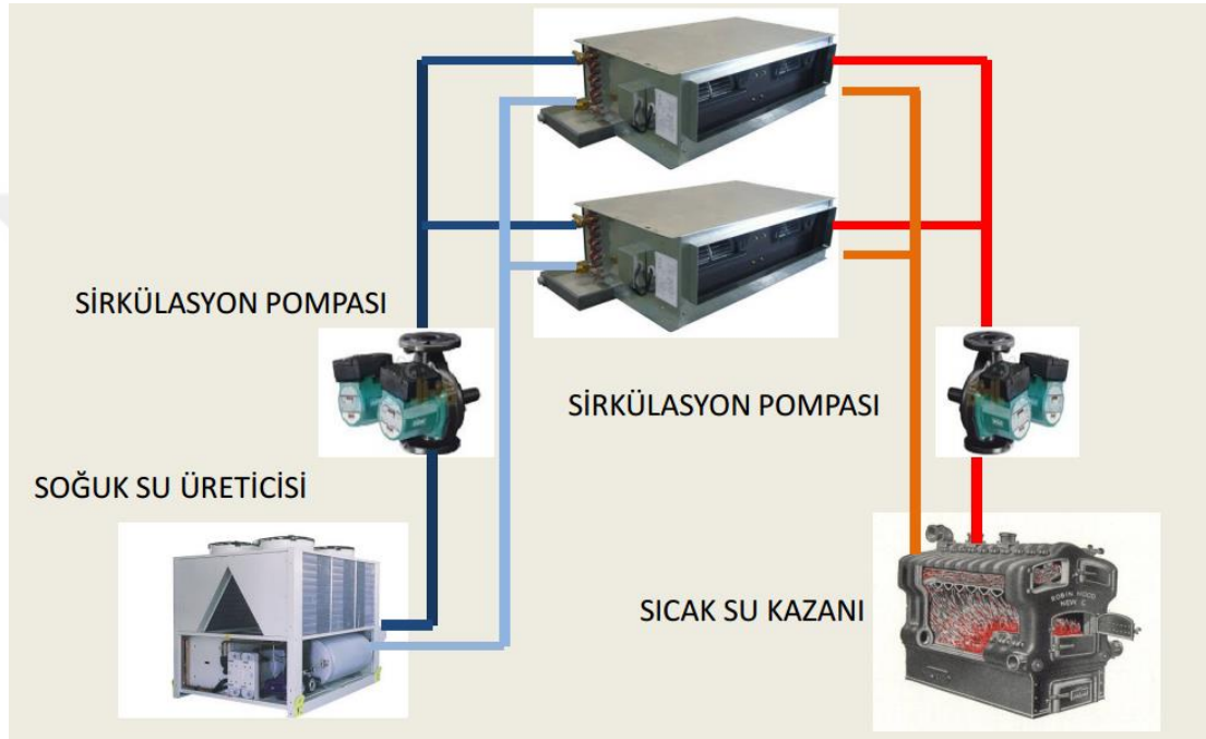
Şekil 3.34: Dört Borulu Fan Coil Sistem (Atalay, 2013; Harran, 2014).
