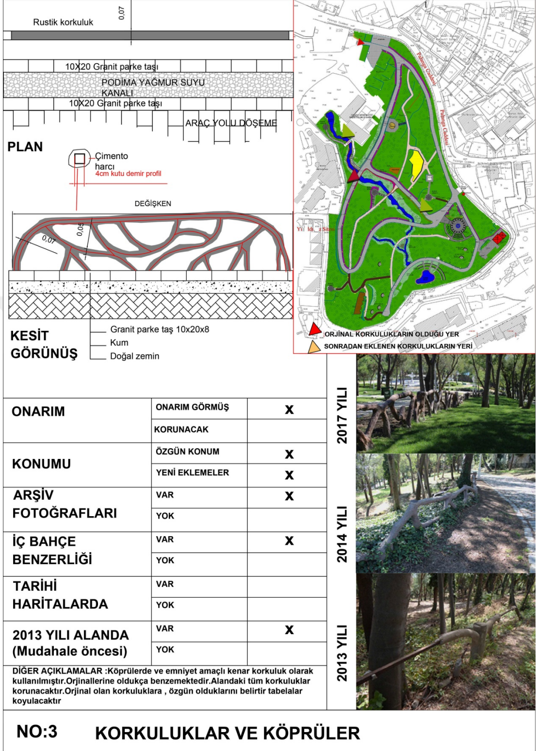
Şekil 5-40 Tarihi korkuluk ve köprülerin alan analizi ve rölöve projesi.
