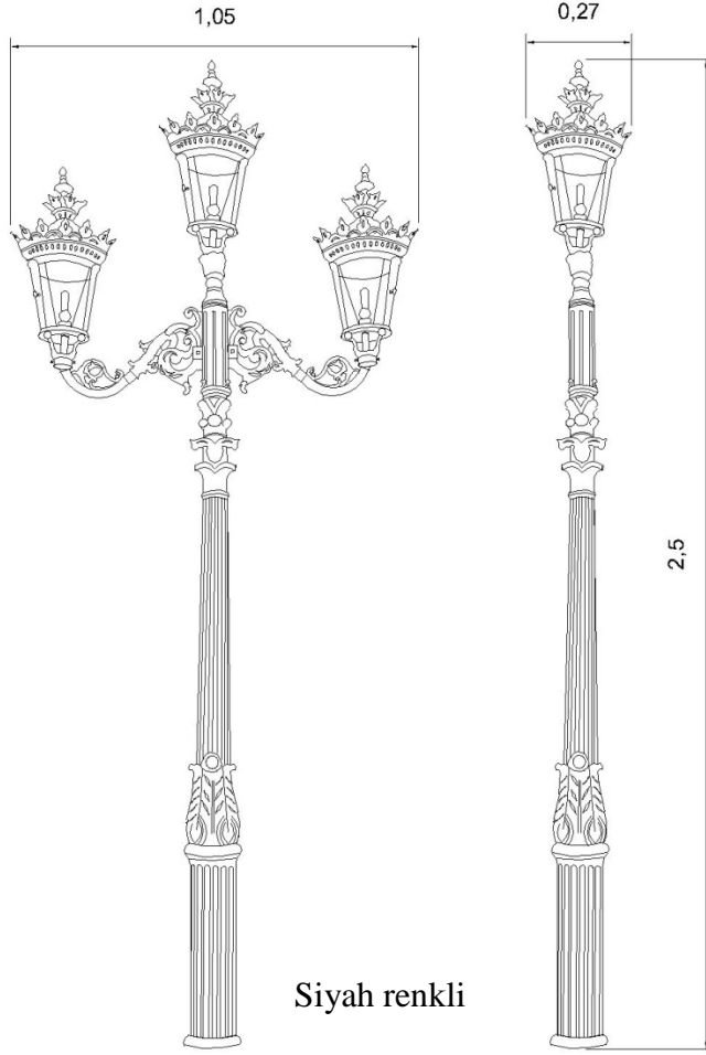
Şekil 5-108 Fener aydınlatmalar restitüsyon ve restorasyonu.
