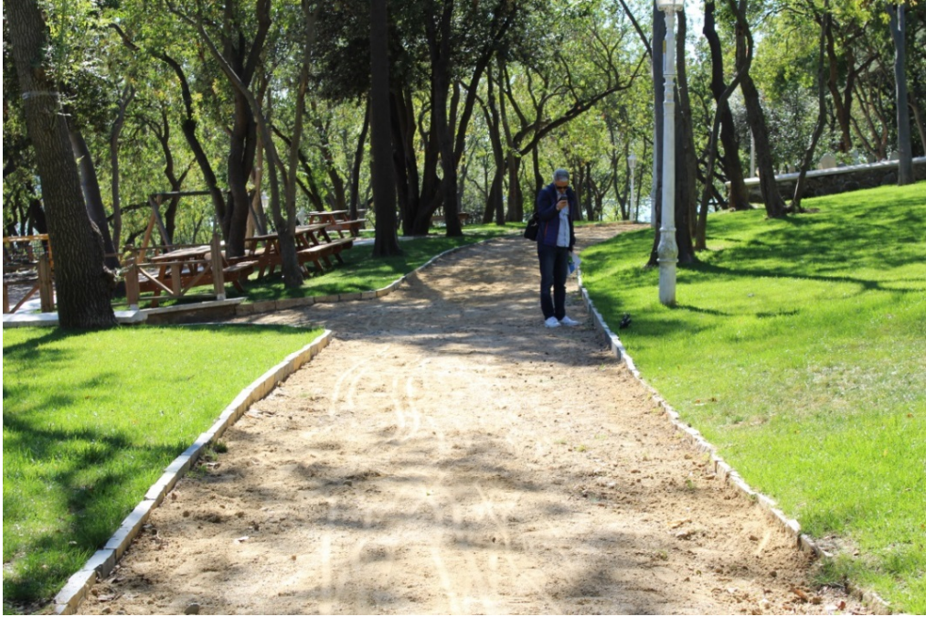
Şekil 5-97 Dişli kum ve kayrak taşının dikey olarak kullanılmasıyla oluşan bordür uygulaması yapılmış patika yürüyüş yolları (ZONTUR, 2017).
