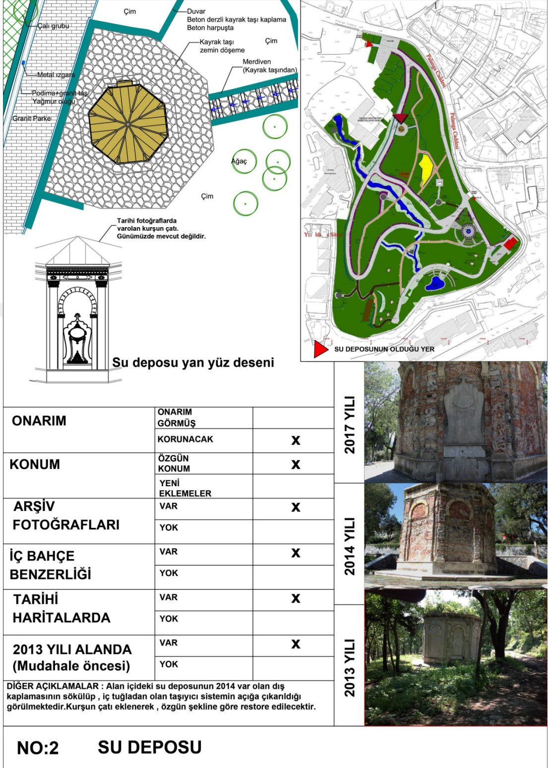
Şekil 5-34 Tarihi su deposu alan analizi ve rölöve projesi
