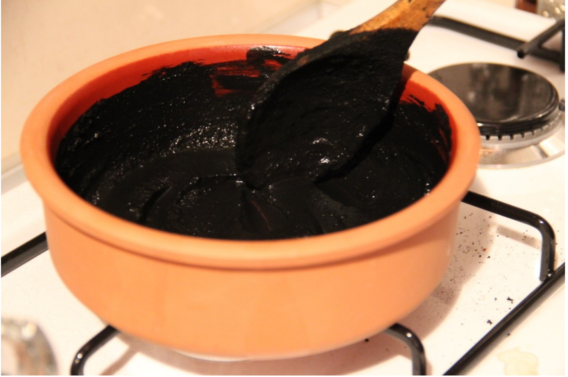
Resim 78: İs boyasının ocakta pişirilmesi.
