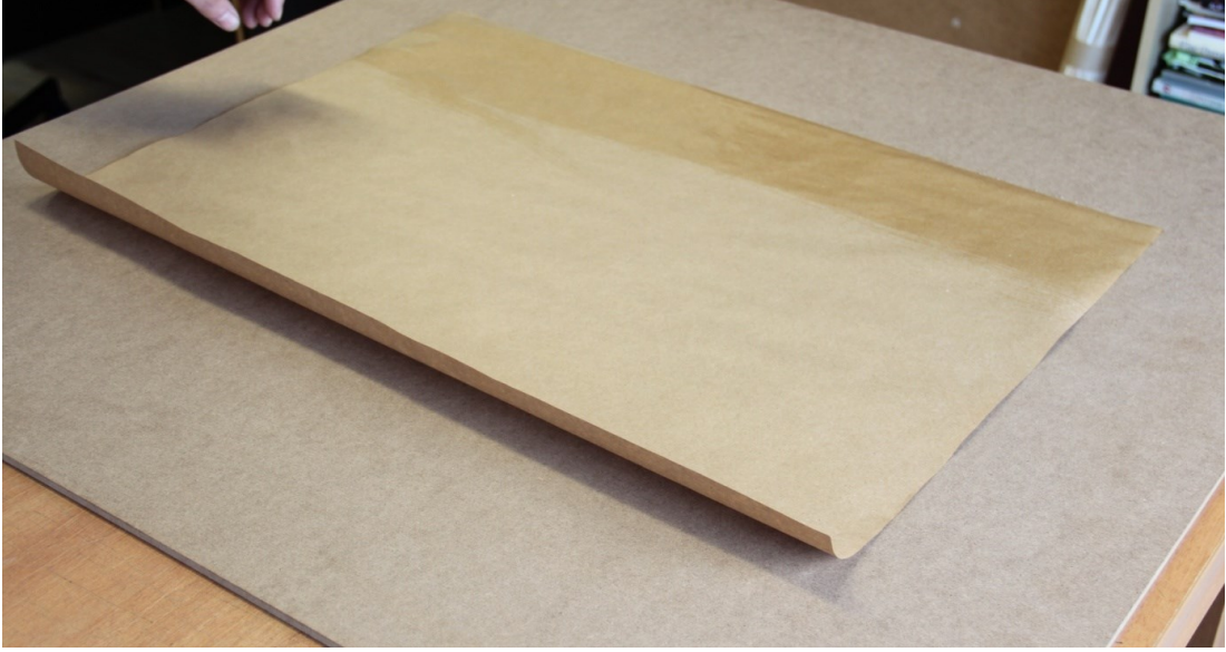
Resim 71: Kağıdın ıslatılarak tavlatılması.
