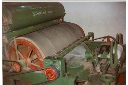
Resim 3.8. Tarak makinesinde yapağının taranması Çanakkale-Ayvacık-Süleymanköy, Servet Senem Uğurlu Arşivi, 1992.
