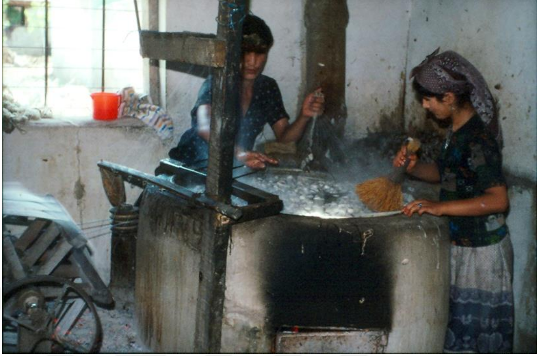
Resim 3.15. Tepme mancınıkta ipek filamentinin çekimi, Aydın Uğurlu Arşivi
