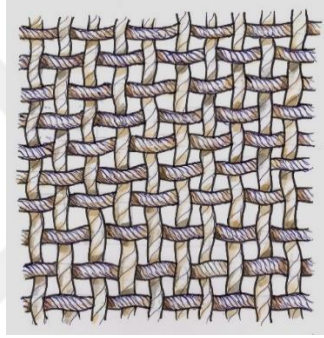
Çizim 4.13. Çok bükümlü atkı, normal bükümlü çözgü, bezayağı dokuma örgüsü, Çizim: Aydın Uğurlu
