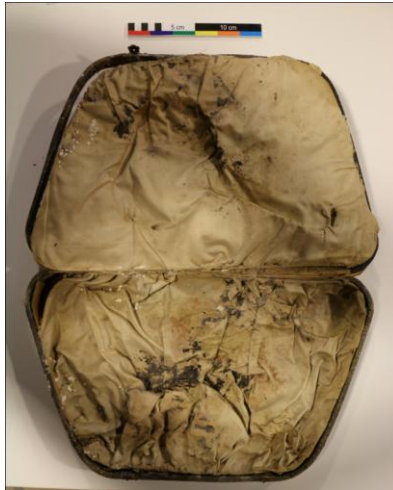
F.76. Kompozit bir eserde (tekstil, kaęıt, ahřap) tekstil üzerinde küflenme ve neden olduęu lekeler (İRKML Arřivi)
