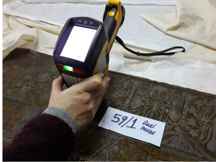
F.141. XRF cihazı ile metal ipliklerle yapılmış işlemlerin analizi (Ayşe Tepeyurt Merav 2014)
