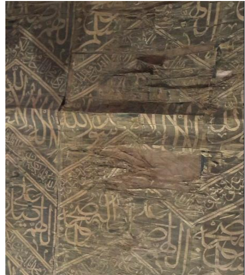
F.80. – F.81. İpekten Üretilmiş Eserlerde Liflerde Kırılma ve Ayrışmalar (İRKML Arşivi)
