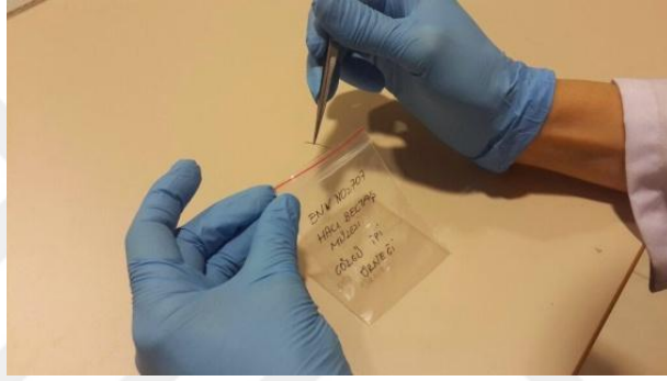
F.135-136. Boyarmadde Analizi İçin Eserin Atkı ve Çözgü İplerinden Örnek Alma (İRKML arşivi)
