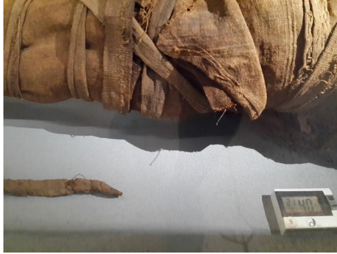
F.52. Viyana Kunst Historisches Museum’da timsah mumyasının içinde sergilendiği vitrinde datalogger ile bağıl nem ve sıcaklık takibi (Ayşe Tepeyurt Merve 2017)
