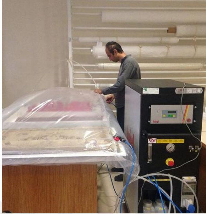
F.74. İstanbul Restorasyon Merkez Laboratuvarı'nda tekstil eserlere azot gazı ile polietilen yalıtım kullanılarak modifiye atmosfer metodunun uygulanması (Ayşe Tepeyurt Merev 2018)
