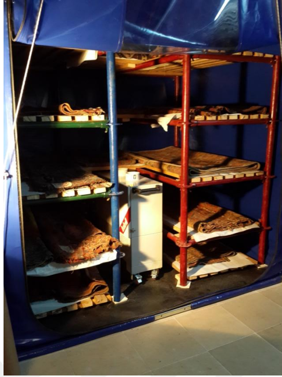
F.75. Modifiye Atmosfer Metodunda Eserlerin Çadıra Yerleştirilmesi (İRKML Arşivi)
