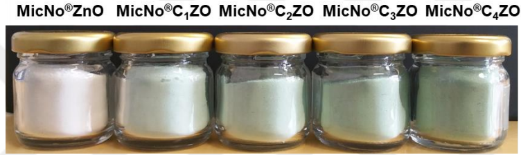
Şekil 5.25. MicNo ® ZnO ve Co katkı konsantrasyonu artması ile birlikte meydana gelen renk değişimi
