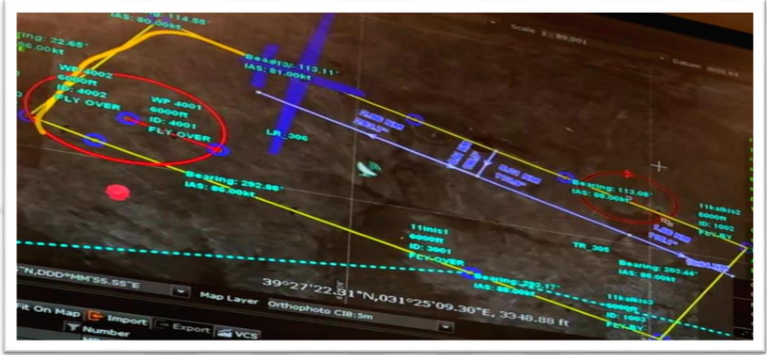
Şekil 2.12. İHA Simülatör RNAV (GNSS) Rwy11 T-Bar Prosedür FAF Noktası Görünümü
