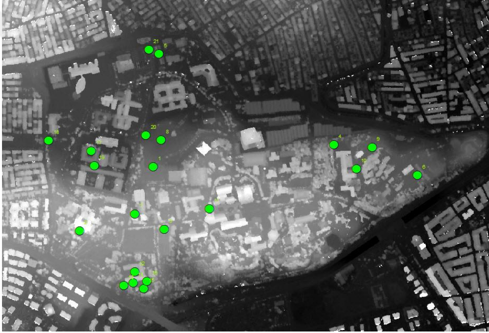
Şekil 7. 2. SYM verisi üzerinde kontrol noktalarının dağılımı (Kaynak: Yazar tarafından üretilmiştir.)
