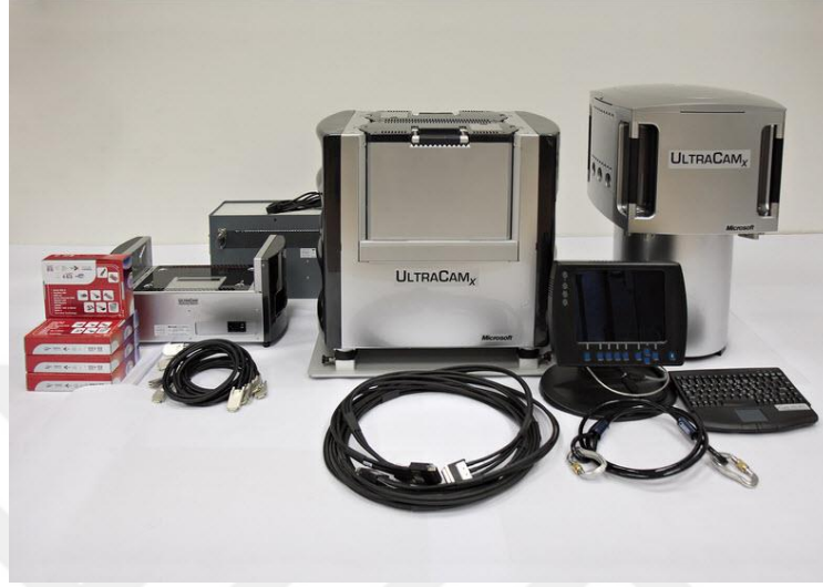
Şekil 4. 10. ÇŞB tarafından kullanılan kamera modeli UltraCamX modeli (http-4)
