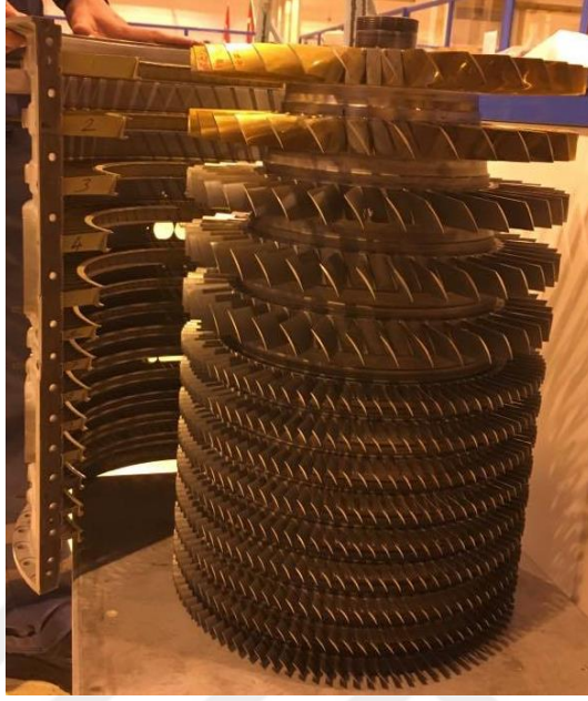
Görsel 4.31. Kompresör rotor ve statorları
