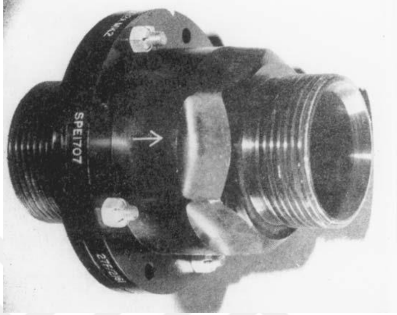
Görsel 3.8. Tek yönlü yakıt hattı valfi (Newton, 1964)
