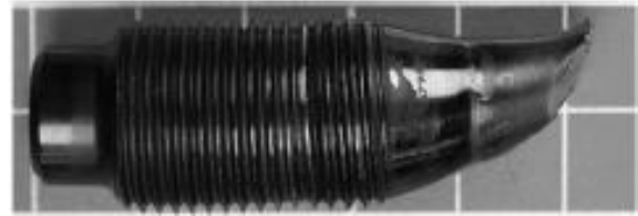
Görsel 3.11. Kırılmış civatalar (a)-(d) (Gonzales, Rivas and Beltran, 2017)
