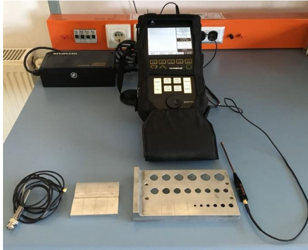
Görsel 3.26. Portatif bir girdap akım test cihazı
