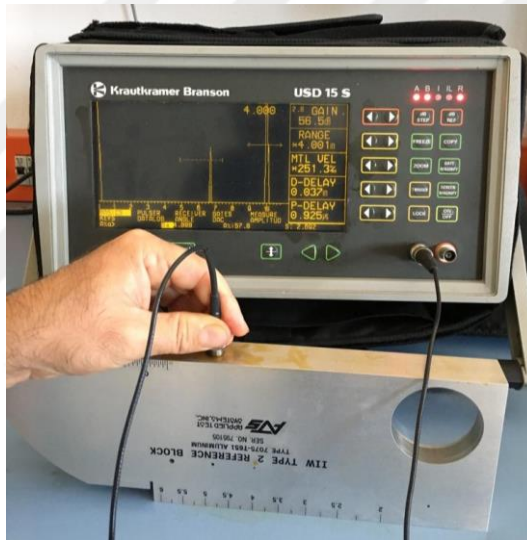
Görsel 3.27. Kalibre bloğu üzerinde test işleminde kullanılan bir ultrasonik muayene cihazı
