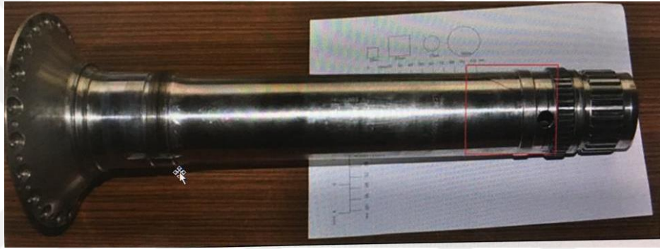
Görsel 4.42. Hasarlı kompresör şaftı
