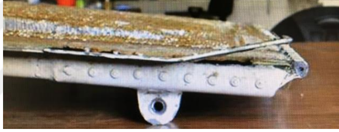
Görsel 4.9. A/I/T iç kapağındaki çatlak
