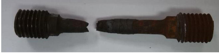
Görsel 3.22. Sürünme deneyi sonrasında test numunesi(Chvostova and Dzugan, 2017)
