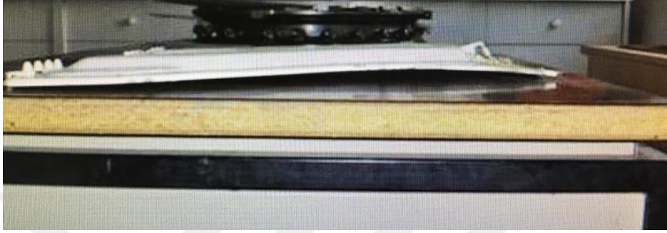
Grsel 4.15. A/İ/T dıř kapađındaki deformasyon
