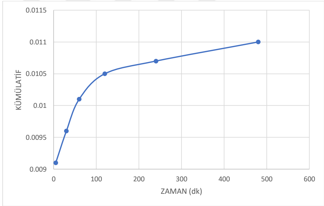
Şekil 4.22. PCL-Gel-B12 nanolifinden B12 vitamini kümülatif ilaç salınımının zamana karşı değişimi
