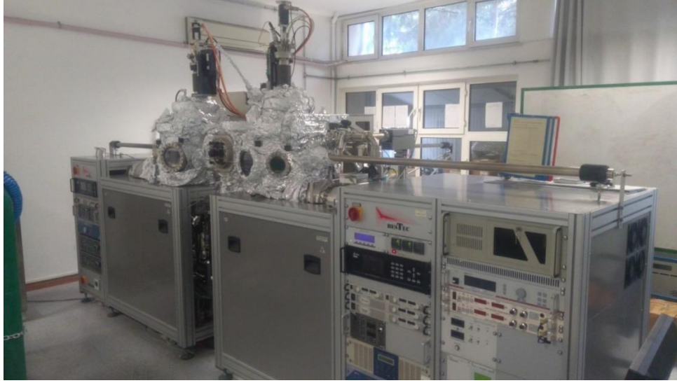
Şekil 2. 4. Anadolu Üniversitesi İleri Teknoloji İnce Film Laboratuvarı'nda bulunan sıçratma sistemi
