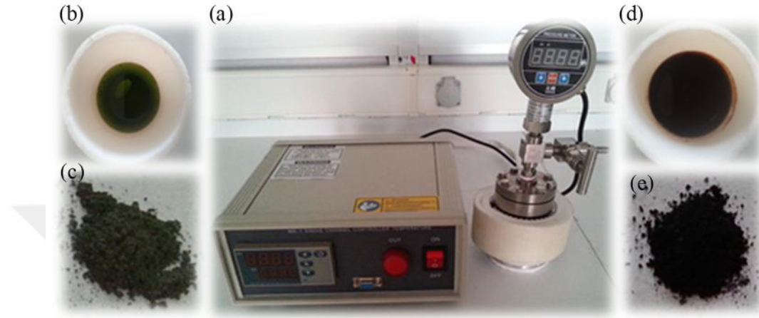
ekil 3.1. CCO ve CFO nanoparçacıkların hidrotermal yöntem ile eldesi: (a) hidrotermal ünite, (b) CCO çözeltisi, (c) CCO tozu, (d) CFO çözeltisi, (e) CFO tozu
