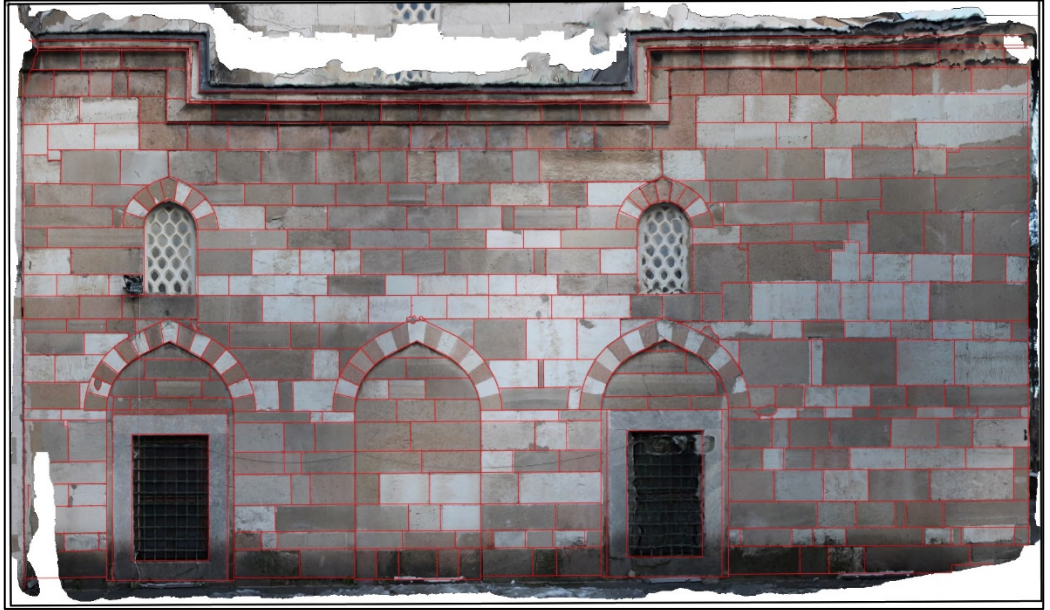
Şekil 6.9 Ortofoto üzerinden gerçekleştirilen rölöve çizimi
