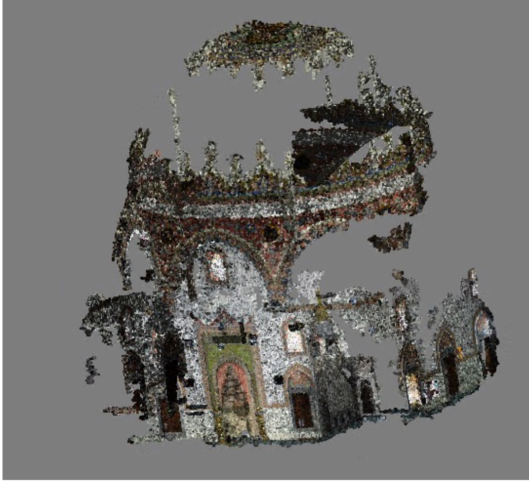
Şekil 5.10 Agresif (Aggressive) derinlik filtresi ile oluşturulmuş yoğun nokta bulutu
