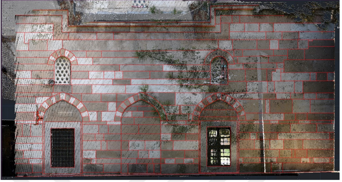
Şekil 6.3 Ortofoto üzerinde gerçekleştirilen rölöve çizimi
