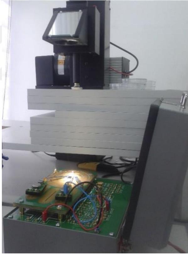
Görsel 3.12. p-n heteroeklem diyotların farklı aydınlatma şiddetlerinde I-V ölçümleri için kullanılan deney düzeneği
