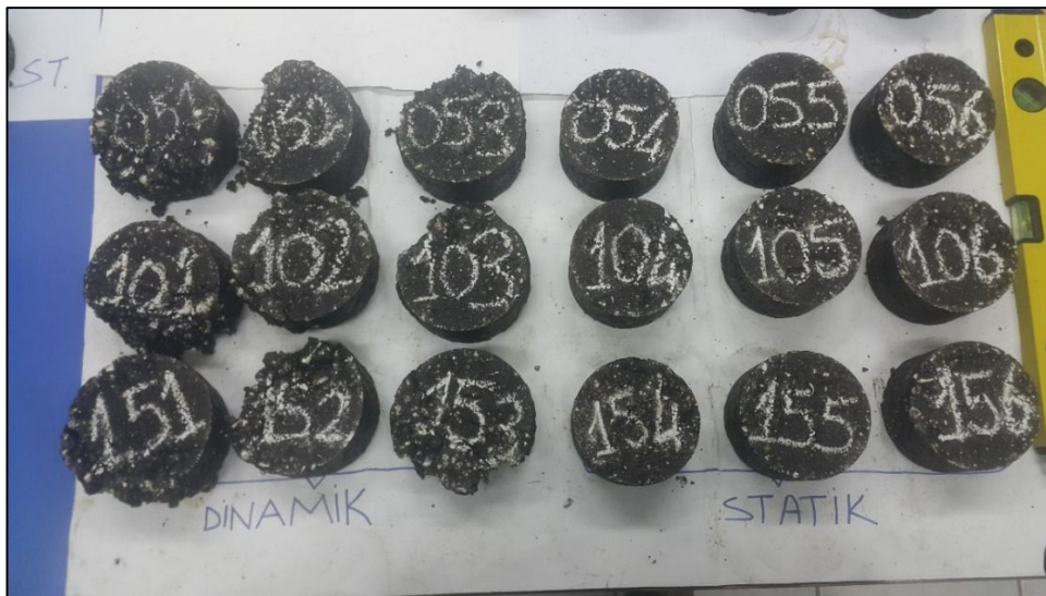
Görsel 5.21. Bitümün ÖAB ile modifiyesi sonucu oluşturulmuş numunelerin sünme deneyi sonrası görüntüleri
