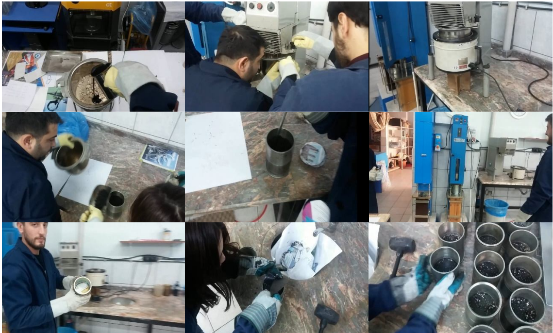
Görsel 5.17. Asfalt betonu numunesi hazırlanması
