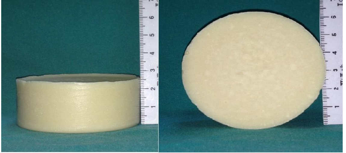
Şekil 2.1.1.1: 60g çimento kalıpta dondurulmuş şekli
