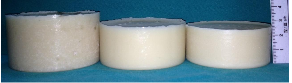
Şekil 2.1.1.2: 60g çimento/4g Tekosit/4g Glukoz, 60g çimento/4g Glukoz, 60g çimento kalıpta dondurulmuş şekli
