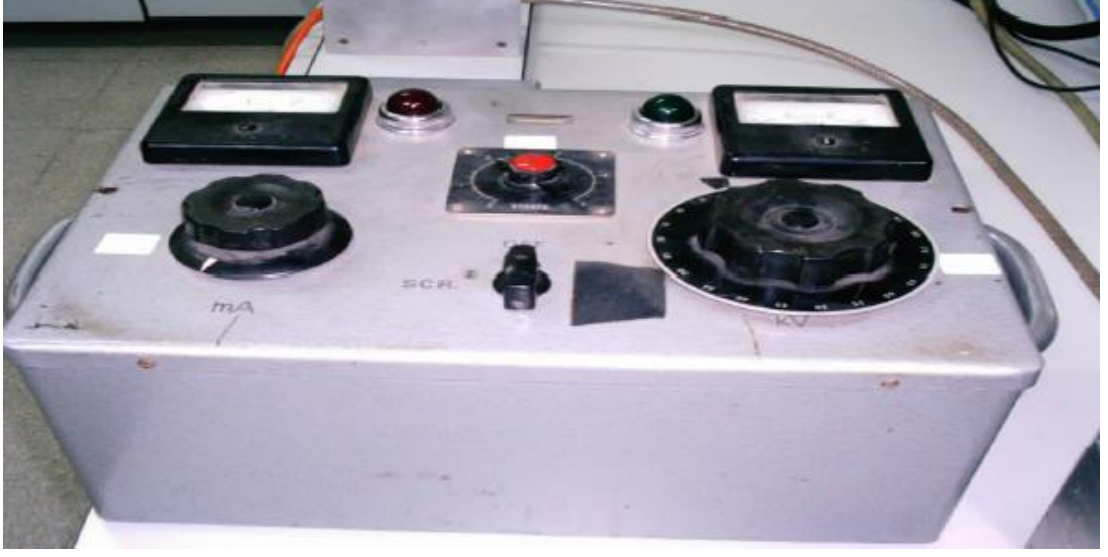
Şekil 3.6 Celal Bayar Üniversitesi Lüminesans Araştırma Laboratuvarında bulunan X Isını Tüpü kontrol ünitesi.
