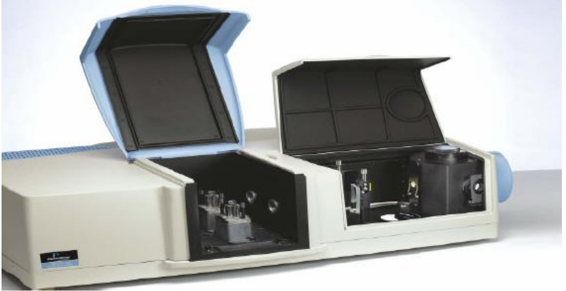
Şekil 3.4 İki farklı örnek odasını da içeren Lambda 950 Spektrofotometresi.
