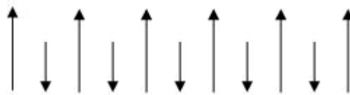
Şekil 2.4. Ferrimanyetik düzene sahip spinlerin temsili gösterimi
