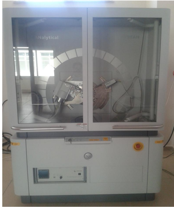
řekil 3.7. Erzincan niversitesi laboratuvarlarında bulunan Panalytical Empyrean marka/model XRD cihazı
