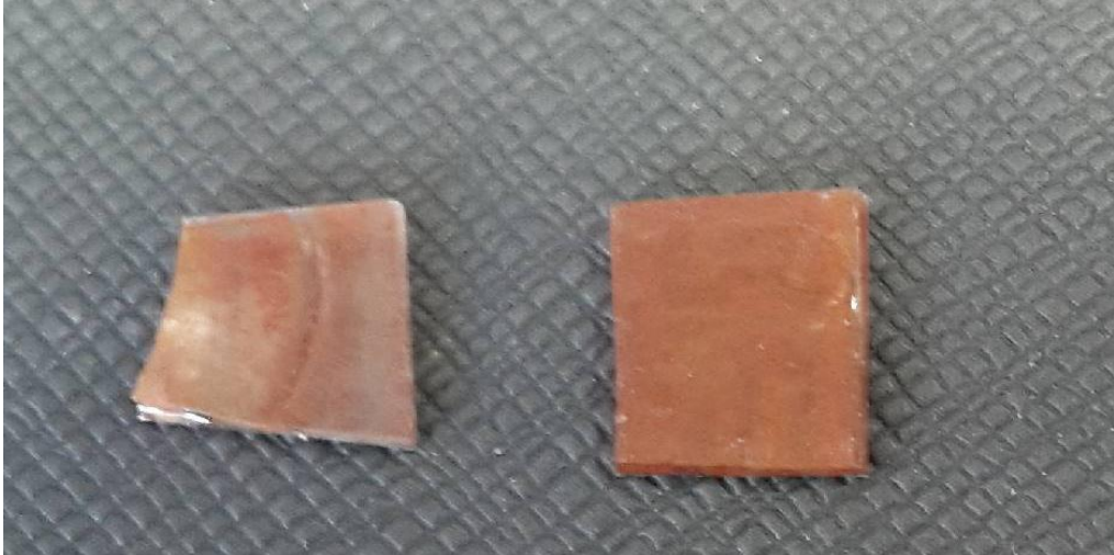
Şekil 3.5. Cam ve ITO altlık üzerine oluşturulmuş kadmiyum oksit filmler
