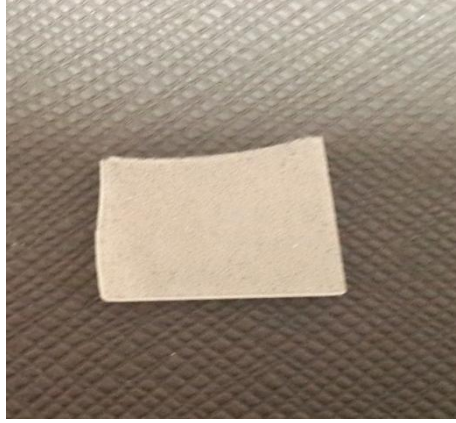
Şekil 3.4. Üç gün süreyle büyütülmüş Cd(OH) 2 yapısı
